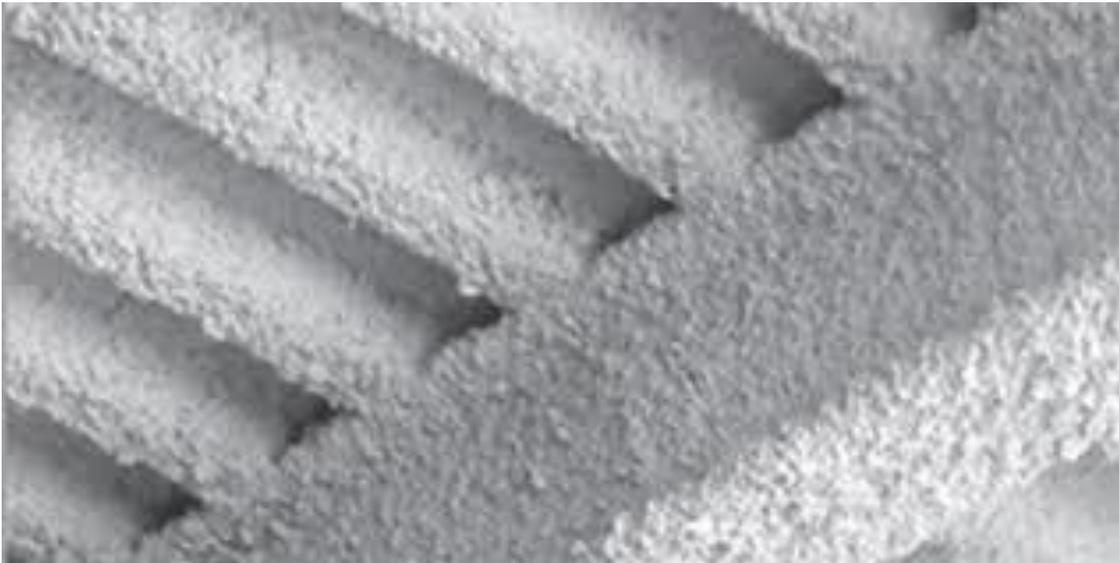
Figura V- 10. Mortero ignífugo.
