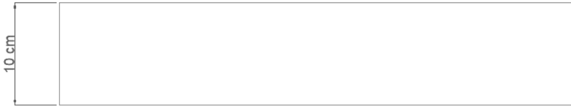
Figura 7.4 - 5. Franja blanca demarcar los sentidos de los carriles de tránsito de montacargas
