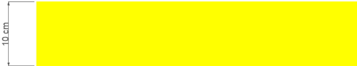
Figura 7.4 - 4. Franja amarilla para demarcar zonas de paso y de almacenamiento
