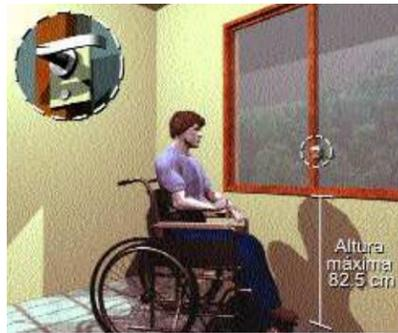
Figura V- 30. Altura máxima de las ventanas.
