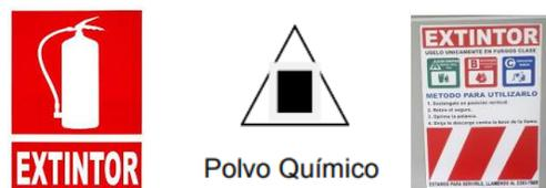
Figura V- 74. Señalización para la identificación de extintores portátiles.
