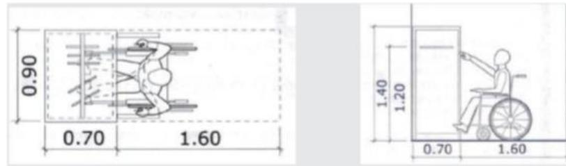
Figura V- 37. Características mínimas para el diseño del closet (mediciones en metros).
