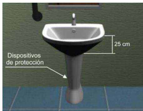
Figura V- 52. Lavatorio accesible y dispositivos de protección.
