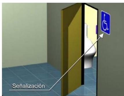
Figura V- 43. Señalización en los servicios sanitarios.
