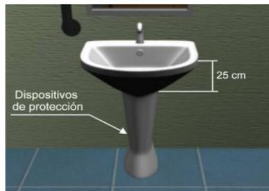
Figura V- 24. Lavatorio accesible y dispositivos de protección.
