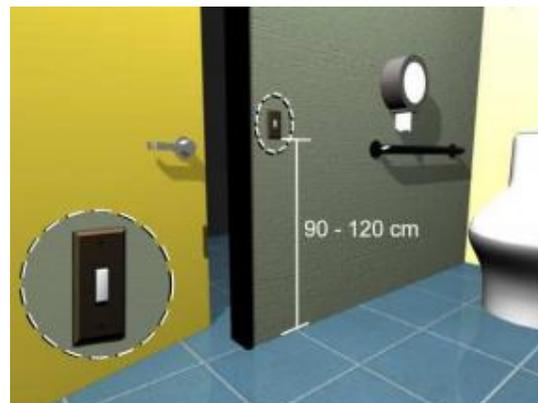
Figura V- 54. Altura de accesorios en los servicios sanitarios accesibles.
