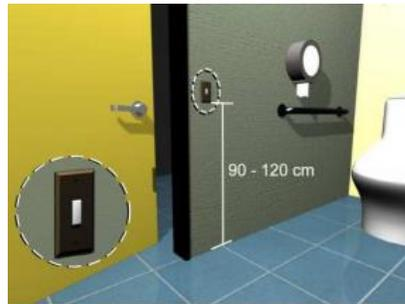
Figura V- 27. Altura de accesorio en los servicios sanitarios accesibles.
