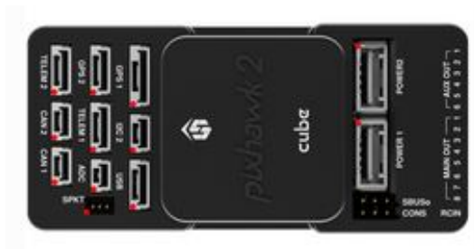
Figura 5.24: PixHawk 2.1 también conocido como Cube flight controller [44].
