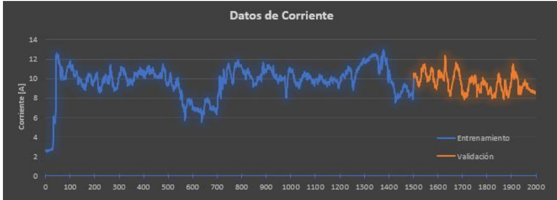
Figura 5.13: Datos de corriente en vuelo utilizados como referencia para la generación de datos sintéticos.
