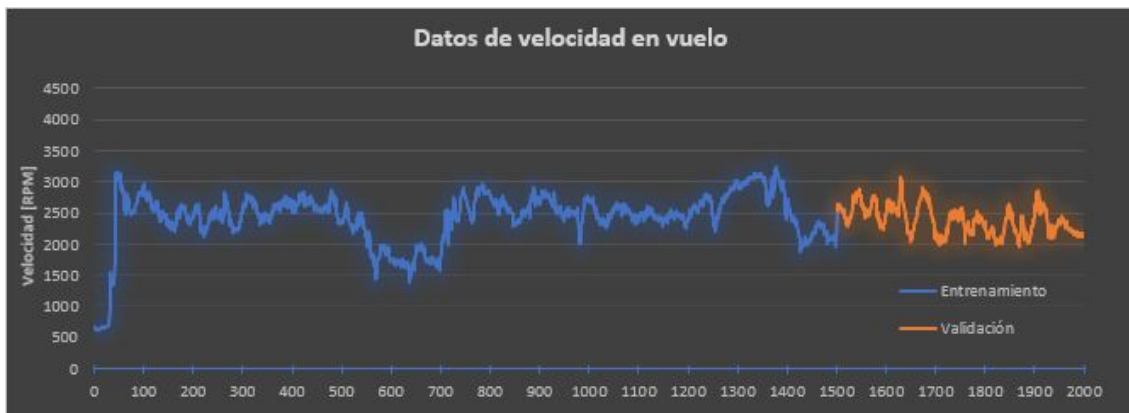
Figura 5.11: Datos de velocidad en vuelo utilizados como referencia para la generación de datos sintéticos.
