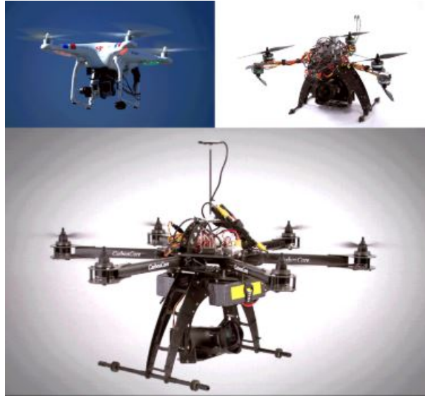
Figura 2.1: Vehículos multirrotores con diferente número de motores. [5]
