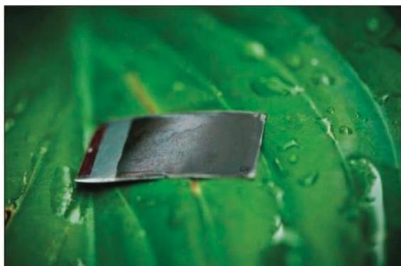
Figura 4.18. Ilustración de la hoja artificial compuesta por una lámina de Si de triple unión recubierta con NiMoZn y Co-OEC (Nocera, 2012).
