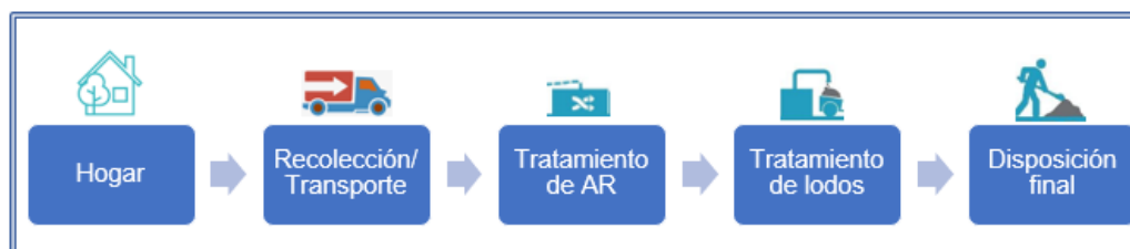
Figura. 2. Ciclo del sistema de aguas residuales urbanas. (Adaptado de Lundin y Morrison (2002))
