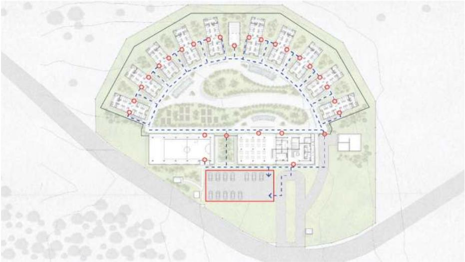
Imagen 130: Ruta de evacuación para todos los usuarios en caso de inhabilitarse el sector dentro de la barrera de seguridad interna.
