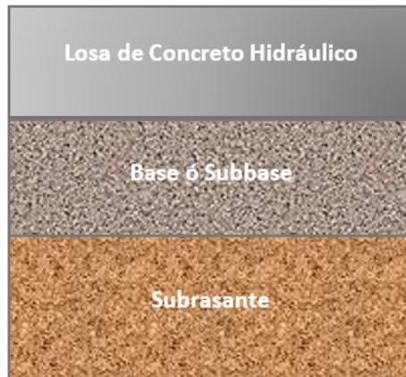
**Figura 4.** Sección típica de pavimento rígido
