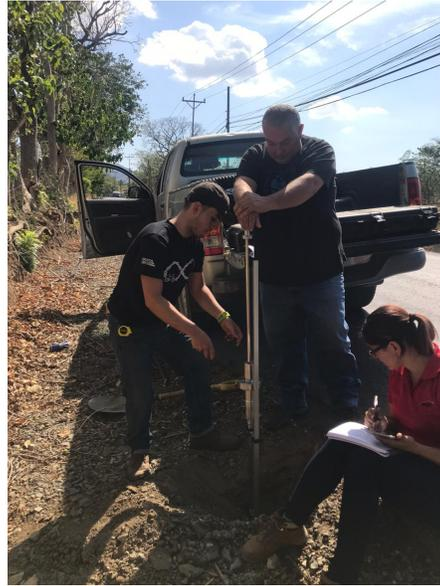
(b) Ensayo de DCP Est. 0+110
