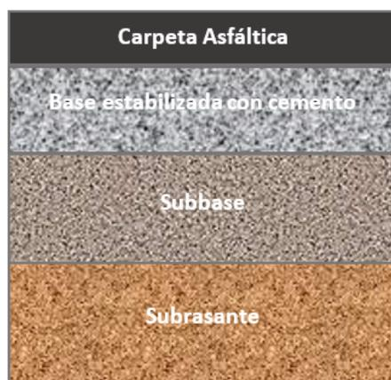
**Figura 9.** Sección típica de pavimento semirígido
