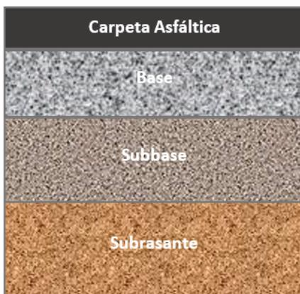
**Figura 3.** Sección típica de pavimento flexible
