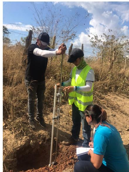
(d) Ensayo de DCP Est. 6+500
