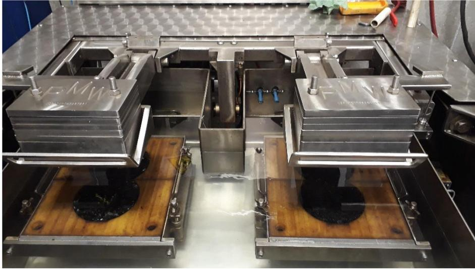
Figura 25. Equipo de Rueda de Hamburgo en proceso de ensayo.
