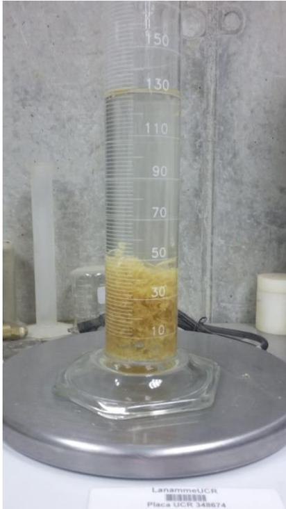
Figura 12. Fibra de bambú en probeta de 250 ml para prueba de densidad mediante volumen desplazado.
