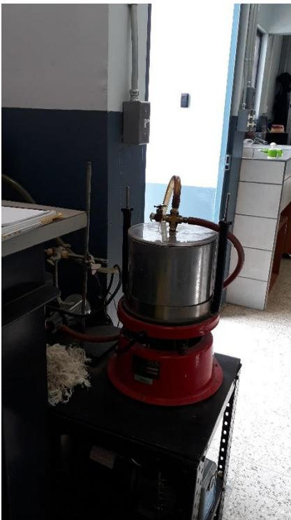
Figura 19. Prueba de gravedad específica bruta. Peso de espécimen
