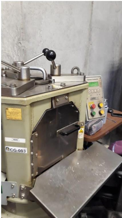
Figura 17. Compactador giratorio Superpave.
