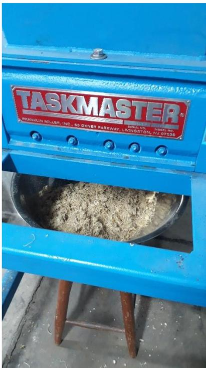
Figura 9. Tamaño reducido de la fibra de bambú en el triturador mecánico.
