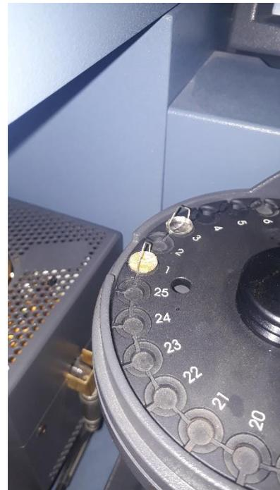
Figura 11. Fibra de bambú en el equipo de Termogravimetría TGA Q5000 V3.17 Build 265
