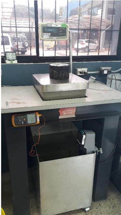
Figura 18. Prueba de gravedad específica máxima teórica. Equipo de vacío a presión
