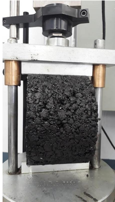
Figura 22. Prueba de Tensión Diametral.
