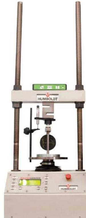
Figura 1. Equipo para prueba Resistencia Retenida a la Tensión Diametral AASHTO T 283. Fuente: Catálogo de ensayos. Lanamme UCR.
