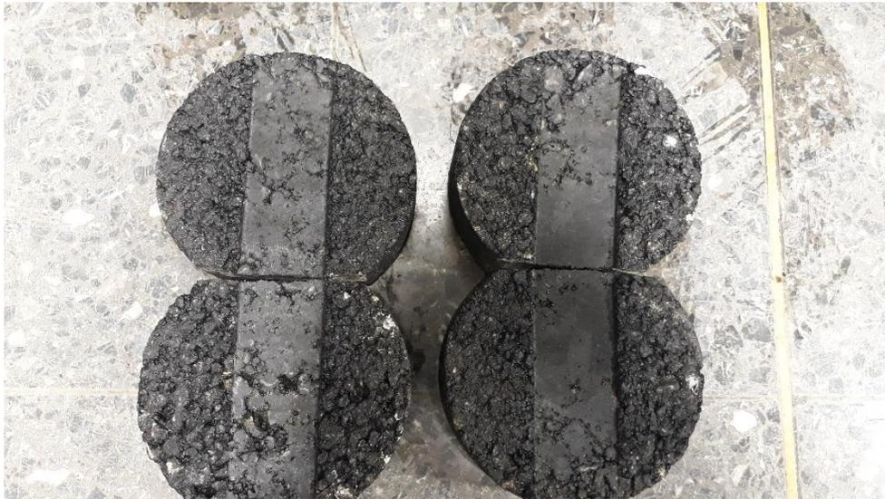
Figura 26. Especímenes ensayados en la prueba de Rueda de Hamburgo.
