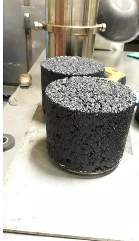
Figura 21. Especímenes compactados para pruebas volumétricas.
