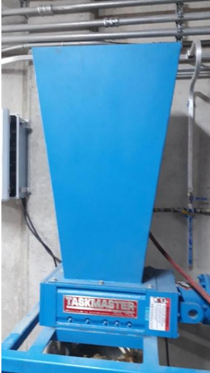
Figura 8. Triturador mecánico utilizado para la fibra de bambú
