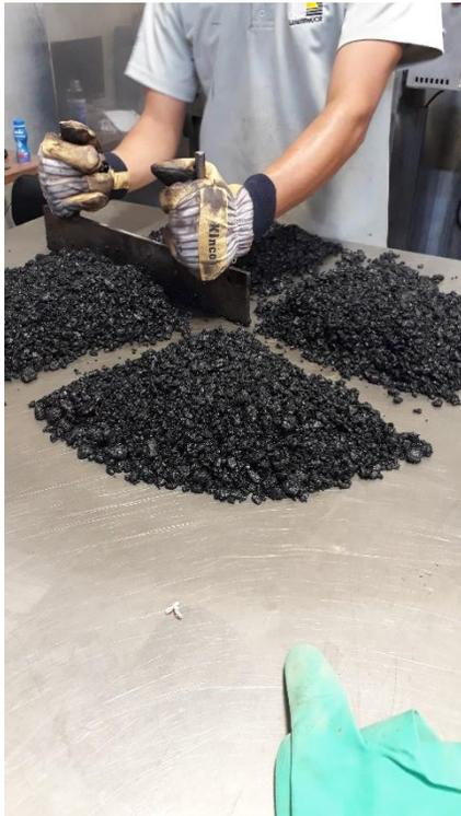
Figura 16. Proceso de cuarteo de mezcla asfáltica.
