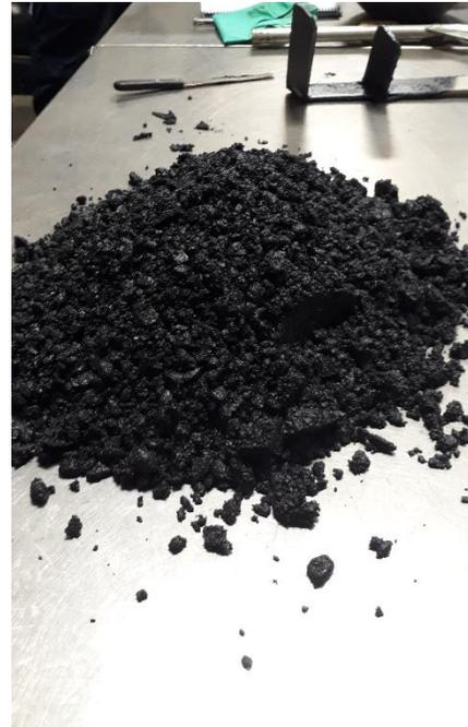
Figura 4. Mezcla asfáltica con fibra de bambú.
