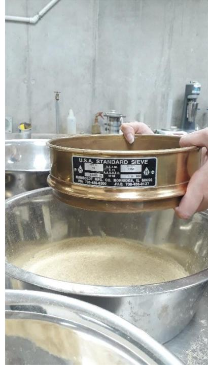
Figura 10. Fibra de bambú en análisis granulométrico malla # 16 (1.18 mm)
