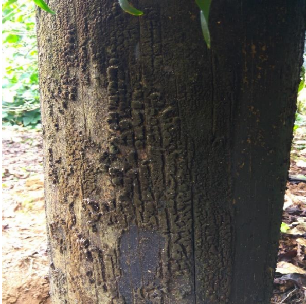
Figura 83. Formación de hongo marrón sobre la superficie del poste.
