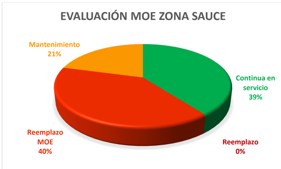
Figura 101. Gráfico cantidad porcentual de la condición de los postes de madera inspeccionados según el valor del MOE en la zona del Sauce.
