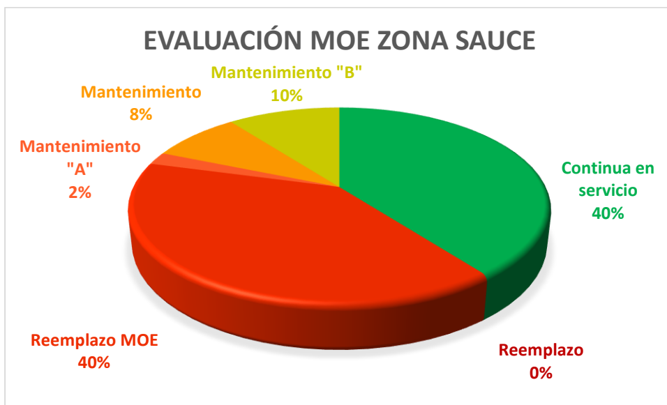
Figura 102. Gráfico cantidad porcentual de la condición de los postes de madera inspeccionados según el valor del MOE en la zona del Sauce.
