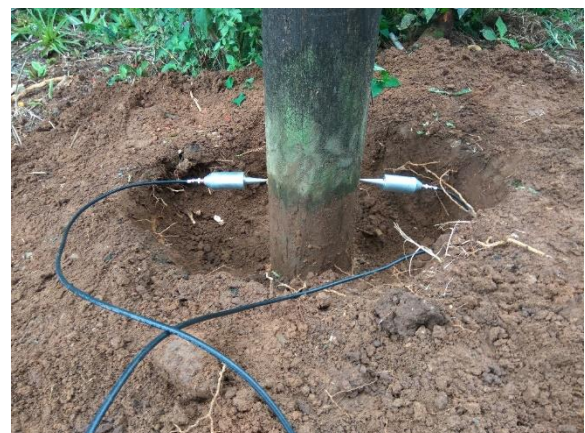
Figura 25. Medición con equipo de ultrasonido.
