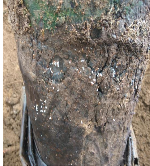
Figura 77. Pudrición a nivel de distancia desenterrada con evidencia de larvas.
