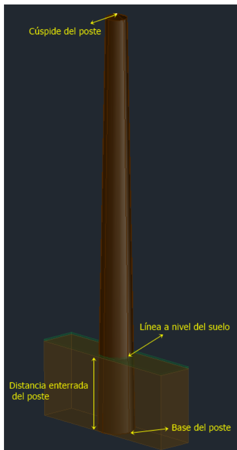
Figura 12. Identificación de la línea a nivel del suelo del poste de madera.
