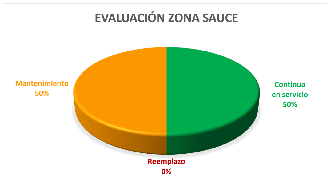
Figura 98. Gráfico cantidad porcentual de la condición de los postes de madera inspeccionados en la zona del Sauce.
