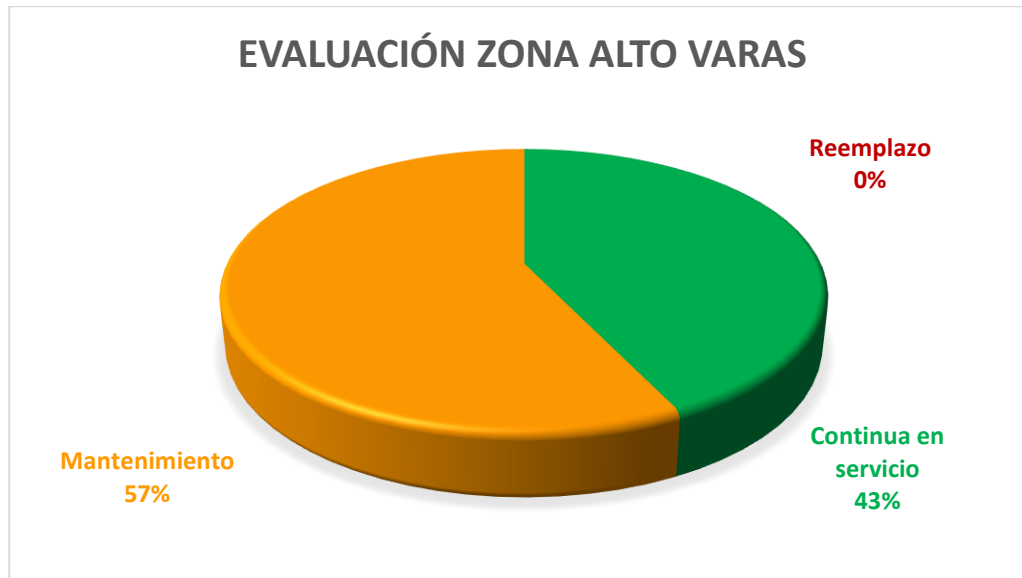
Figura 97. Gráfico cantidad porcentual de la condición de los postes de madera inspeccionados en la zona de Alto Varas.
