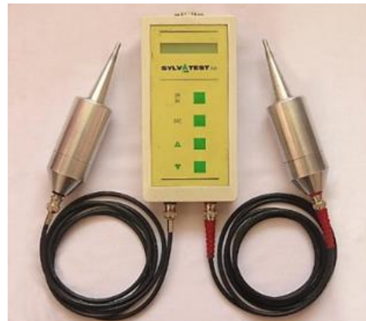
Figura 23. Equipo de ultrasonido SYLVATEST DUO. Fuente. sciencedirect.com
