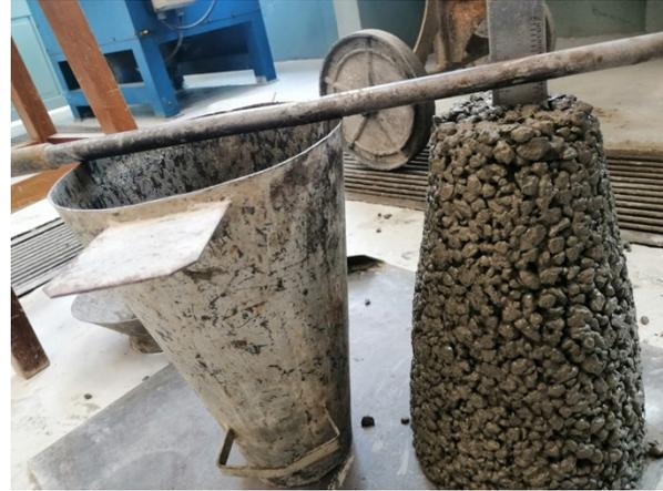
**Figura 19:** Ejemplo de medida de prueba de asentamiento del concreto.
