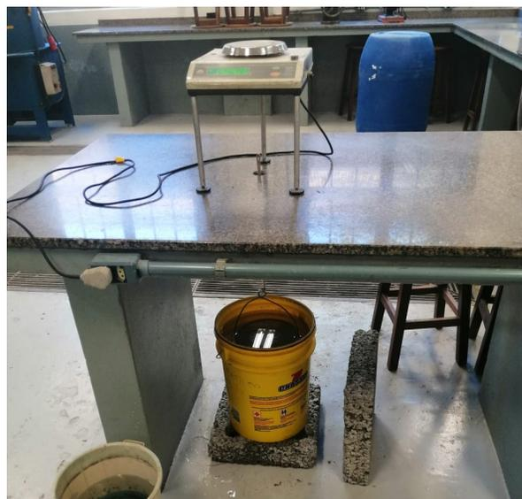
**Figura 14:** Colocación del equipo para medir la masa de agregado grueso sumergida en agua.
