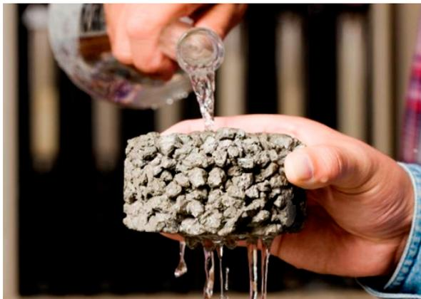
**Figura 2:** Concreto hidráulico permeable (Fuente: Revista Construcción y Tecnología en Concreto, (2019).)
