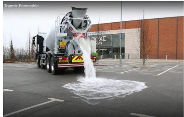
**Figura 4:** Estacionamiento de concreto permeable (Fuente: ArcGIS StoryMaps, (2019).)
