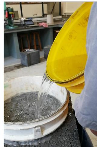
**Figura 28:** Ensayo de permeabilidad en ejecución.
