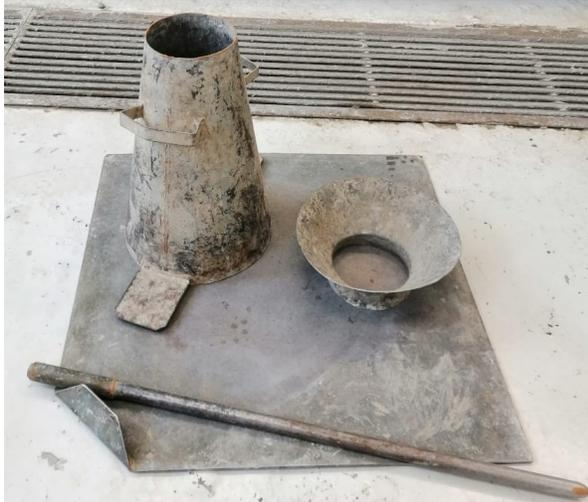
**Figura 18:** Equipo necesario para prueba de asentamiento del concreto.
