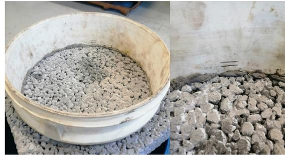
**Figura 27:** Línea de referencia de nivel en anillo.
