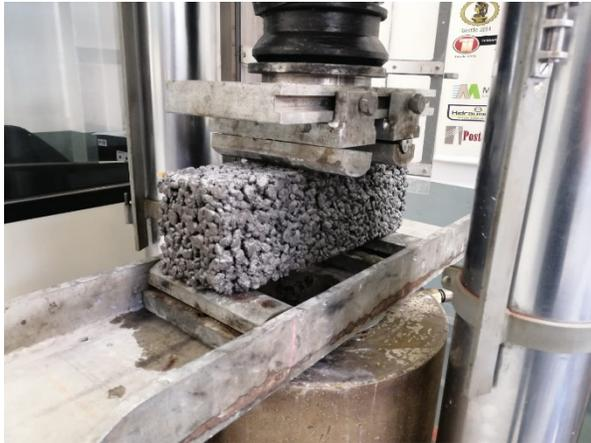
**Figura 32:** Colocación de equipo para ensayo de resistencia a la flexión.
