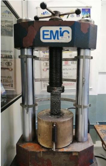
**Figura 29:** Ejemplo de colocación para ensayo de resistencia a la compresión.
