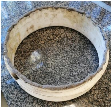
**Figura 26:** Anillo de infiltración con pasta de calafateo.
