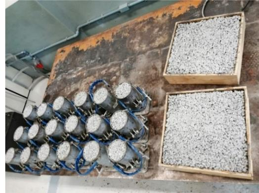
**Figura 22:** Cilindros y placas después de aproximadamente 24 horas del moldeado.
