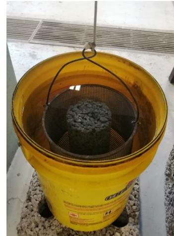
Figura 24: Colocación de cilindros para tomar valor de masa sumergida.
