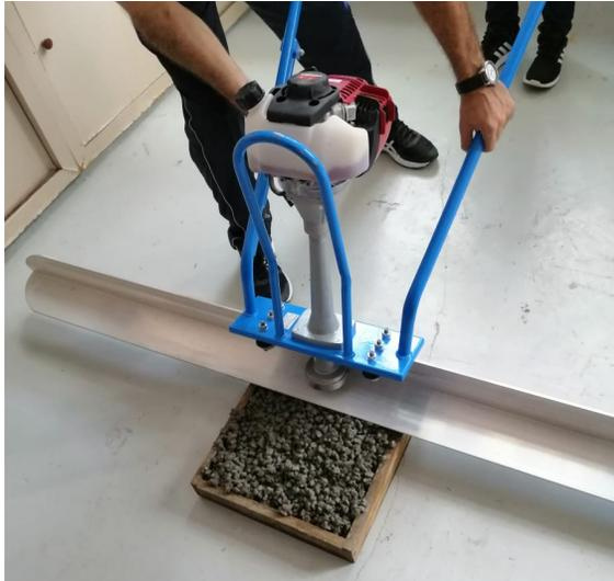
**Figura 21:** Compactación de las placas de concreto.
