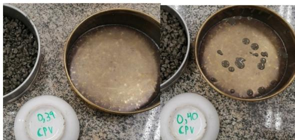
**Figura 17:** Ejemplo del experimento de obtención de la relación a/c por el método de Nguyen.
