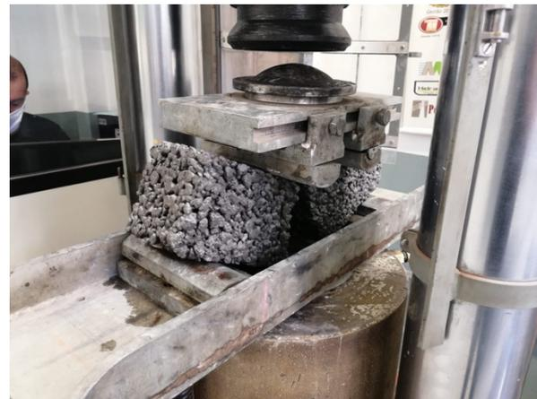
**Figura 34:** Ruptura de prisma en prueba de flexión.
