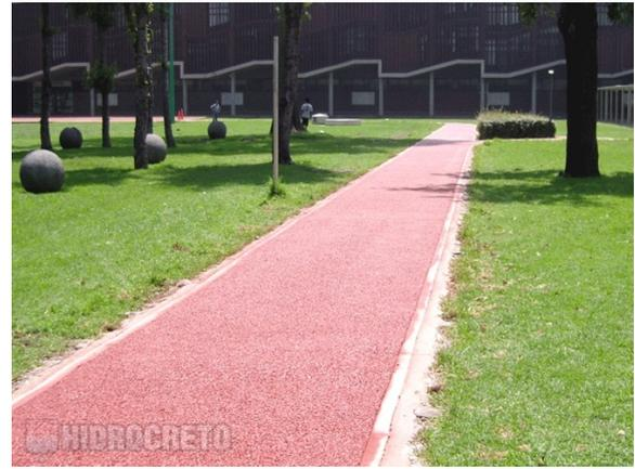
**Figura 3:** Ciclo vía de concreto permeable (Fuente: Hidrocreto, (S.F.).)
