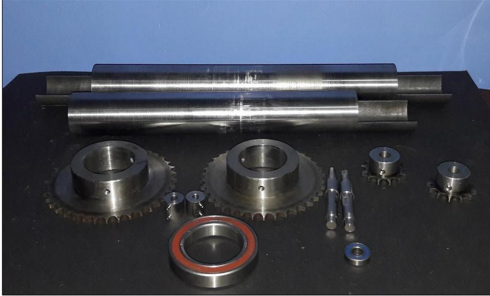
**Figura 47.** Ejes principales, ejes intermedios, catalinas, acoples y algunos rodamientos.
