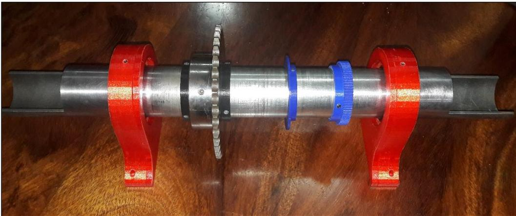
**Figura 50.** Ensamble de eje de elevación.
