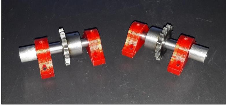
**Figura 49.** Ensamble de ejes intermedios.
