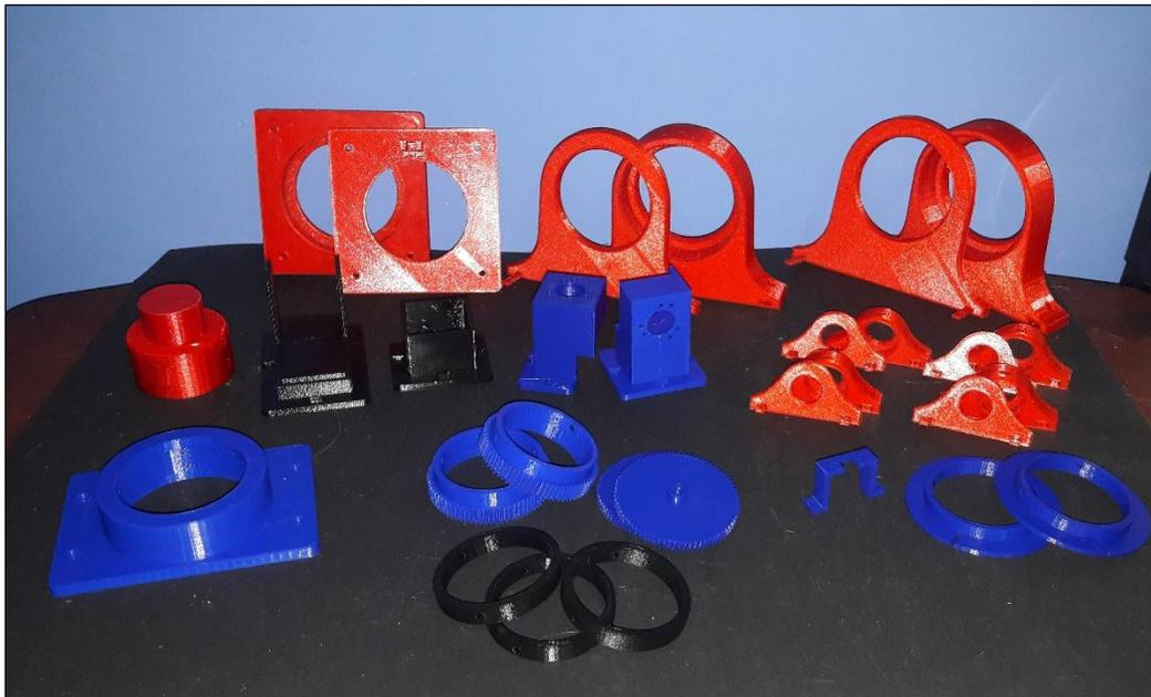
**Figura 46.** Piezas impresas en 3D para el prototipo. Piezas de PLA en azul, de PLA reforzado en negro y de PETG en rojo.
