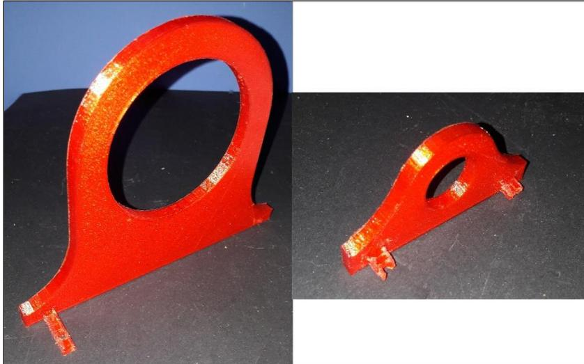
**Figura 40.** Fallas de piezas 3D durante el ensamble.
