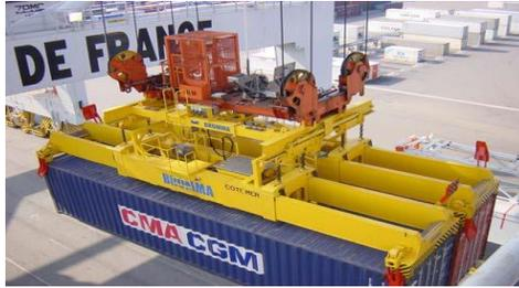
Figura 3.3 Spreader tandem. Fuente: Bromma [10]
