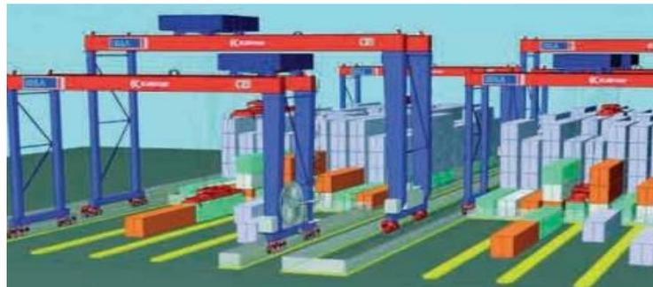
Figura 3.14 Representación de grúas apiladoras automatizadas equipadas con un sistema de grúas porticadas sobre raíles de tamaños distintos. Fuente: Planificación de operaciones [1]
