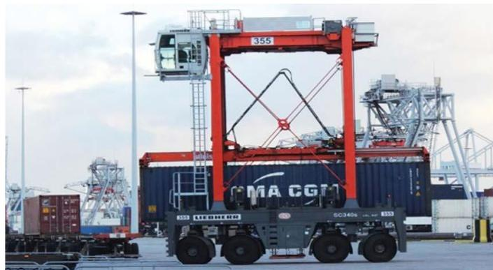
Figura 3.9 Straddle Carrier en ECT Rotterdam Fuente: Liebherr [10]
