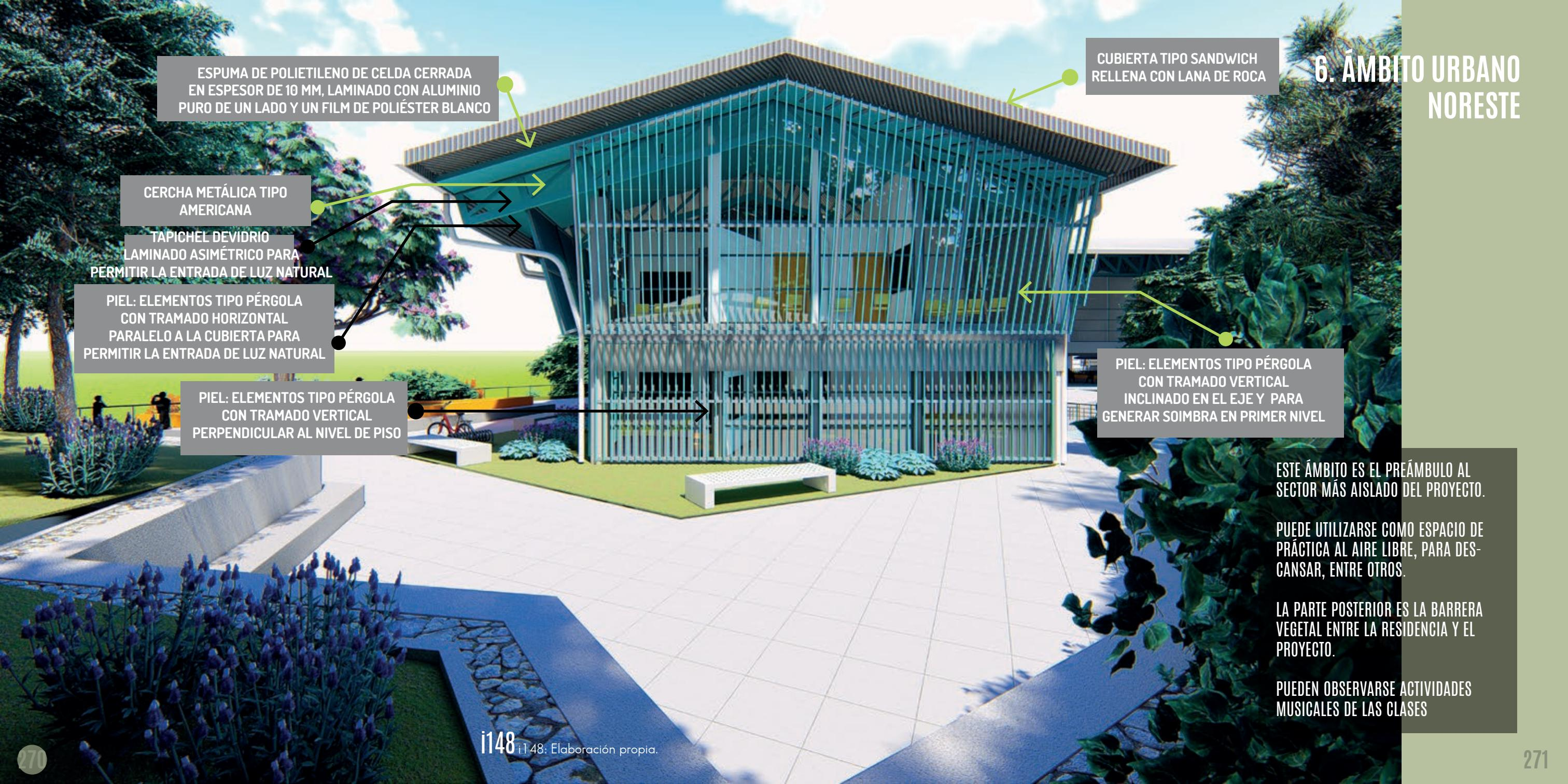
ESPUMA DE POLIETILENO DE CELDA CERRADA EN ESPESOR DE 10 MM, LAMINADO CON ALUMINIO PURO DE UN LADO Y UN FILM DE POLIÉSTER BLANCO
