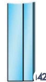
se logra un elevado desempeño de control acústico, gracias a las propiedades amortiguadoras y flexibilidad del PVB\*\*, utilizado en el vidrio laminado. La configuración asimétrica del vidrio reduce la capacidad del sistema de desarrollar vibración por resonancia.
