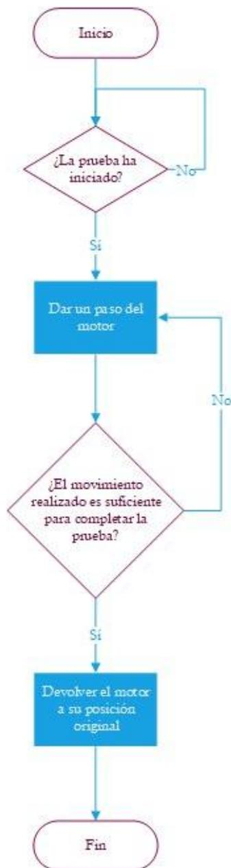
**Figura 3.31:** Diagrama de flujo para controlar el motor [Elaboración propia]
