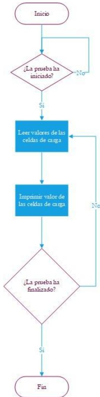
**Figura 3.32:** Diagrama de flujo para controlar las celdas de carga [Elaboración propia]
