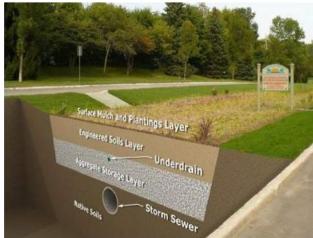
Imagen C5.2. Dren filtrante con capas granulares
