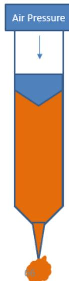
**Figura 7.** Sistema de aplicación por principio neumático.
