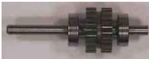
**Figura 13.** Rotor de un motor a pasos de imán permanente
