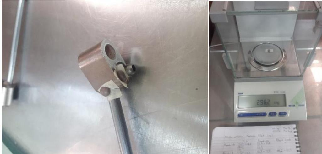
**Figura 23.** Medición experimental de masa para la pieza 4768.
