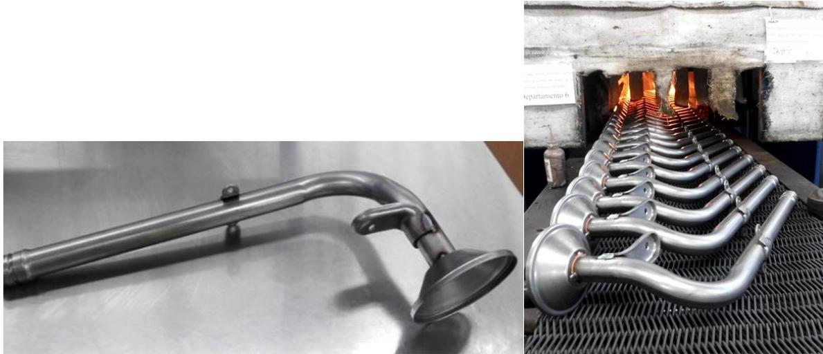
**Figura 21.** Piezas 6615 tratadas en horno de soldadura.
