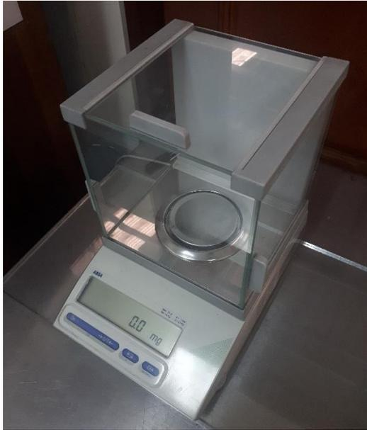
**Figura 20.** Balanza analítica empleada para la medición de masa de pasta de soldadura.
