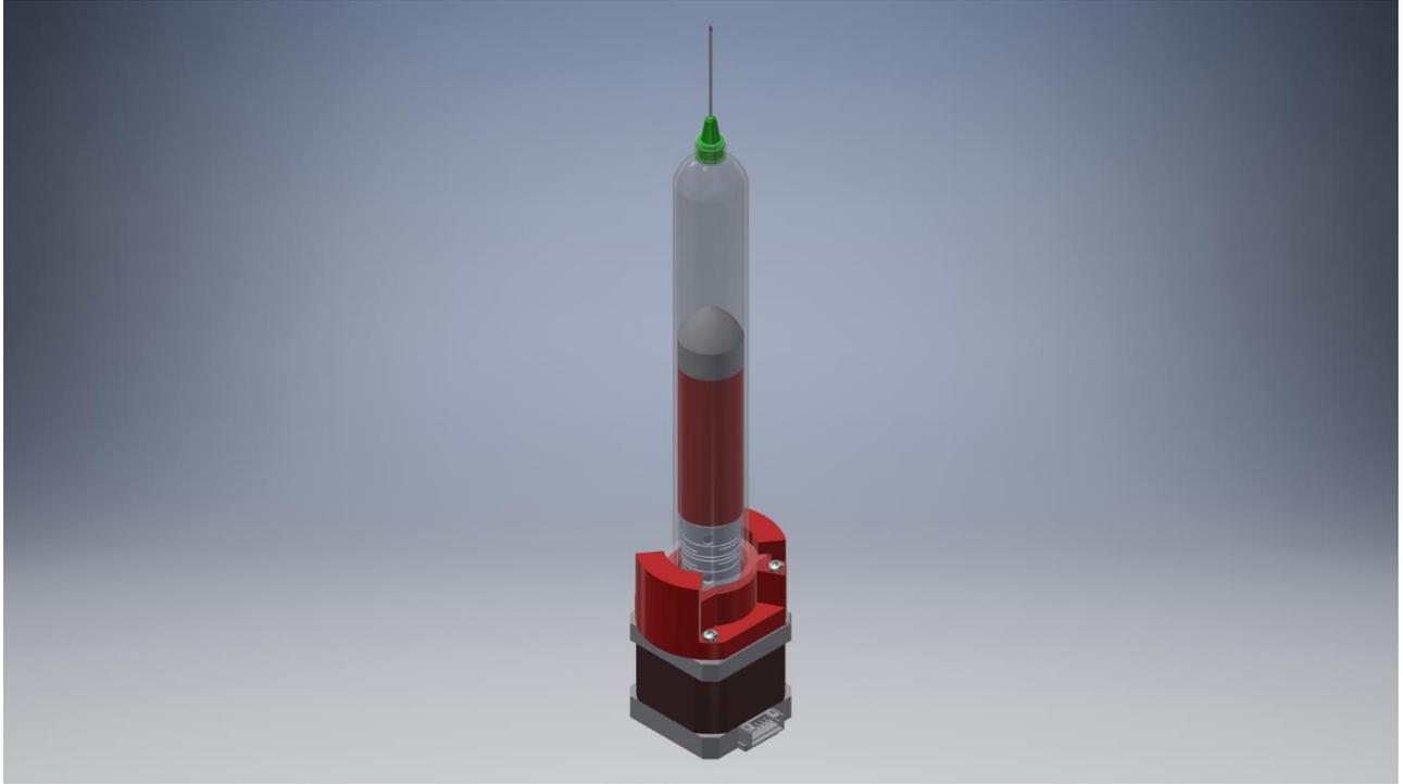
**Figura 35.** Diseño de prototipo dispensador programable.
