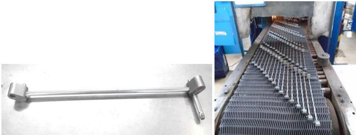
**Figura 22.** Piezas 4768 tratadas en horno de soldadura.
