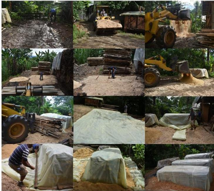
**Figura 4.** Preparación del sitio para difusión de la madera y tapado de pilas de madera para inicio del proceso de difusión, en el aserradero Maderas S&Q, Pérez Zeledón, Costa Rica.
