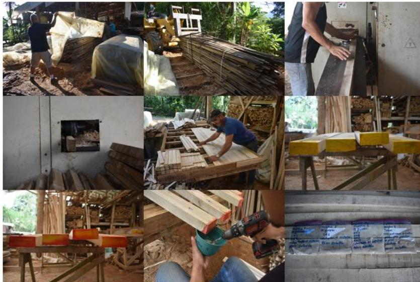
**Figura 5.** Extracción de madera del proceso de difusión, procesos de manufactura, prueba de penetración y obtención de muestras para retención en el aserradero Maderas S&Q, Pérez Zeledón, Costa Rica.
