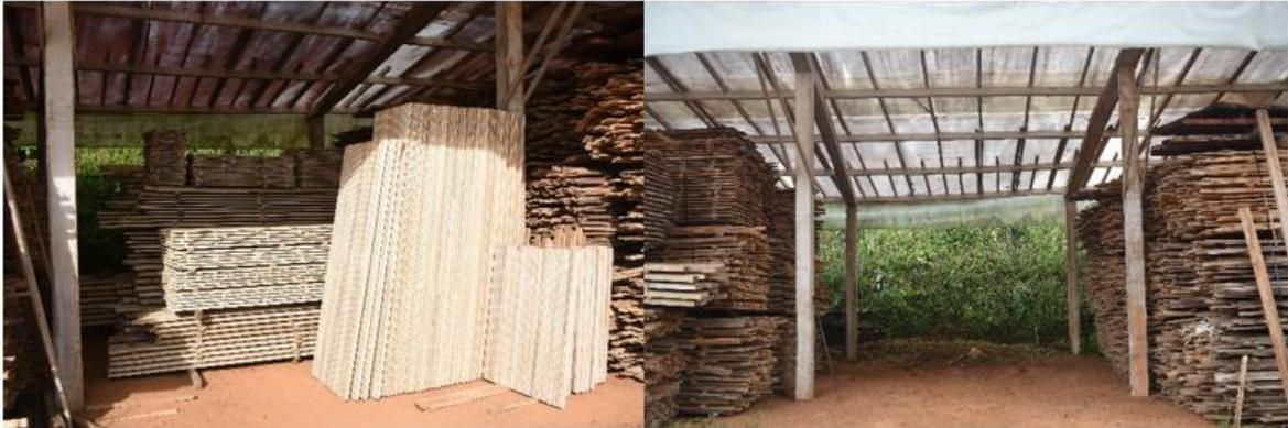
**Figura 6.** Secado de las piezas de madera de *G. arborea* en el aserradero Maderas S&Q, Pérez Zeledón, Costa Rica.
