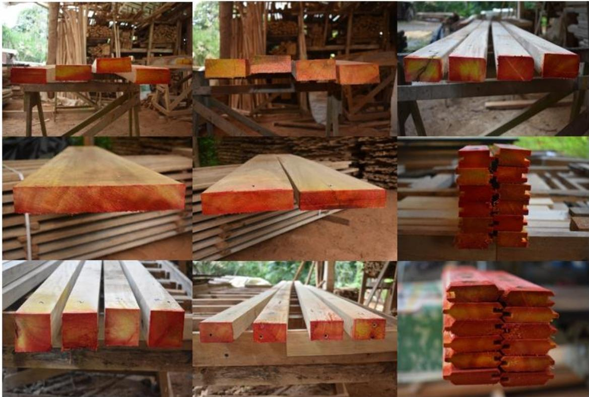
**Figura 19.** Coloración tomada por las piezas de madera de *G. arborea* al aplicar el reactivo para la determinación del porcentaje de penetración del preservante, en el aserradero Maderas S&Q, Pérez Zeledón, Costa Rica.
