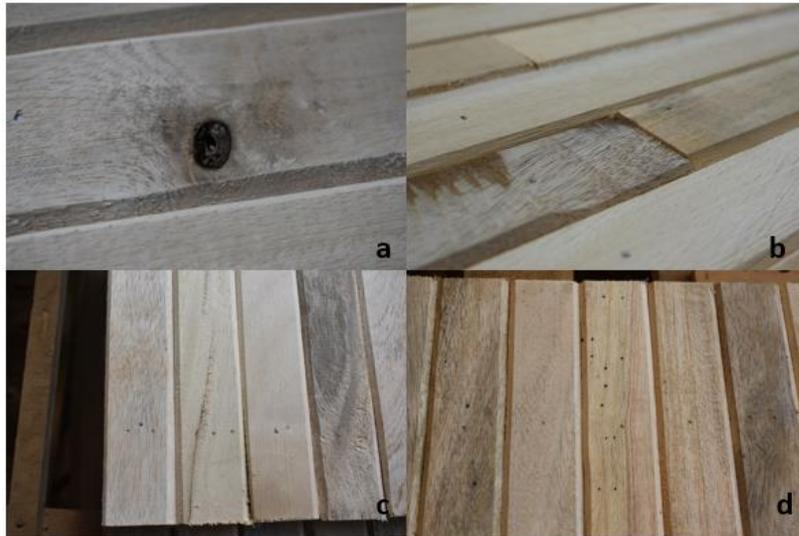
**Figura 12.** Defectos encontrados en los paneles para pared evaluados en el aserradero Maderas S&Q, Pérez Zeledón, Costa Rica. (a: nudo muerto, b: marca de sierra, c: rajadura, d: pique de montaña)
