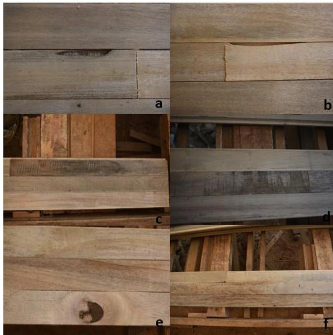
**Figura 15.** Defectos encontrados en los paneles para piso evaluados en el aserradero Maderas S&Q, Pérez Zeledón, Costa Rica. (a: médula, b: arista faltante, c y d: marca de sierra, e: nudo muerto, f: pique de montaña)
