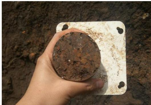
*Figura 9. Extracción de cilindros de suelo*
