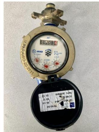
**Figura 3.** Hidrómetro propiedad del acueducto. Fuente: fotografía propia.
