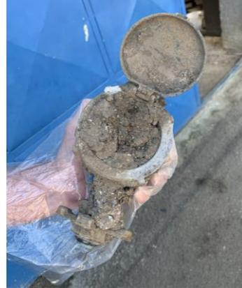
**Figura 26.** Evidencia de hidrómetro retirado dañado por concreto. Fuente: fotografía propia.
