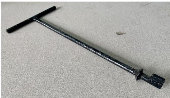
**Figura 40.** Llave de apertura de caja de protección de hidrómetros. Fuente: fotografía propia.
