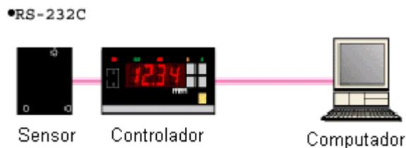
**Figura B2.13** Conexión del sensor por medio del Puerto RS-232.
