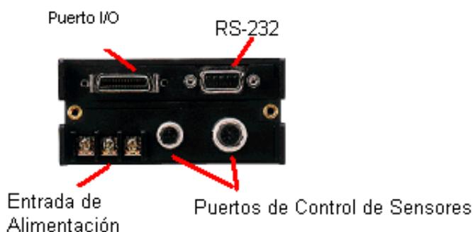
**Figura B2.12** Fotografía de las I/O que presenta el controlador del sensor de Cortina Láser.
