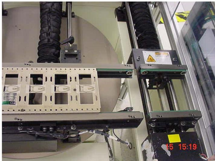
**Figura 6.6** Enrutador en la posición 0°. La banda transportadora pequeña logra la conexión del enrutador con el cargador o Loader.
