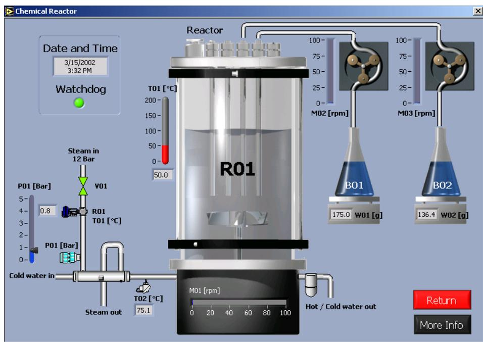
**Figura 5.1** Ejemplo de Interfase Grafica para un Reactor Químico, creada por medio de LabVIEW.
