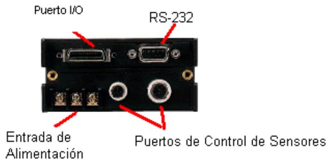
**Figura 4.7** Fotografía de las I/O que presenta el controlador del sensor de Cortina Láser.
