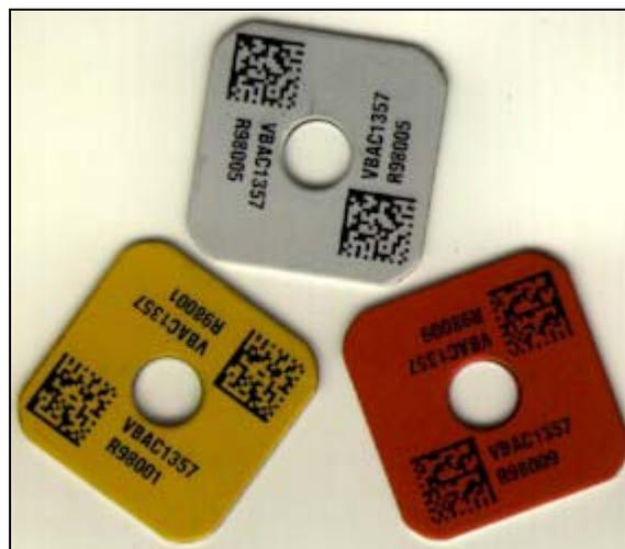
**Figura 4.9** Ejemplo de aplicación de la marca de matriz de 2D en diferentes tipos de metales.
