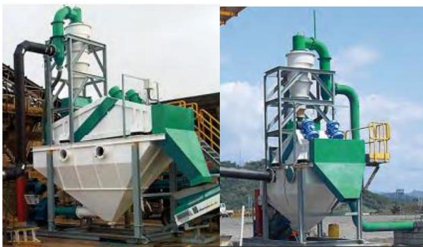
Figura 5: Ejemplos de planta compacta de hidrociclonado.
