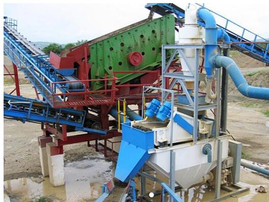
Figura 17: Ejemplo de planta compara de hidrociclonado, criba y bandas transportadoras.
