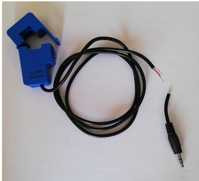
Finalmente, se instala el circuito como se muestra en la figura 23 de manera que permite obtener la corriente eléctrica con un método no invasivo por el sensor de corriente utilizado, siendo así más fácil de manipular para las mediciones al no tener que desconectar el cable de corriente.
