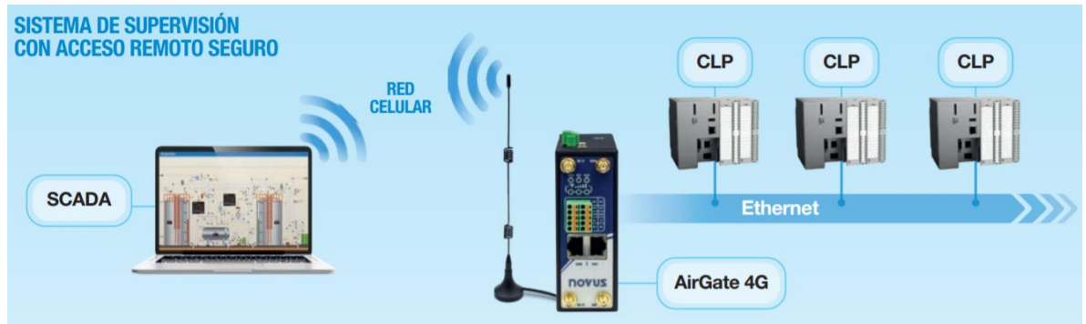
Figura 3-4. Topología de un enrutador VPN celular industrial con puertos ethernet.
