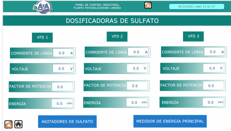
Figura 6-11. Medidor de energía de dosificadoras de sulfato.
