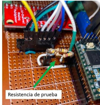
Fig. B-6.2-9. Posición de resistencia de precisión.
