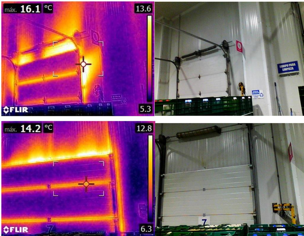
Figura A.5.4; Imágenes tomadas por cámara termográfica FLIR E5 al portón #7 de entrada/salida de producto terminado de la Antecámara con los camiones, sucursal Dos Pinos Coronado.
