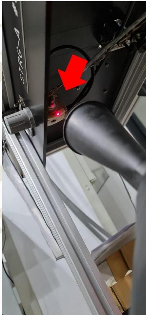
Fuga #5, 53 dB registrados, STRG-A#3, en el block de válvulas, el racor con salida de manguera transparente .
