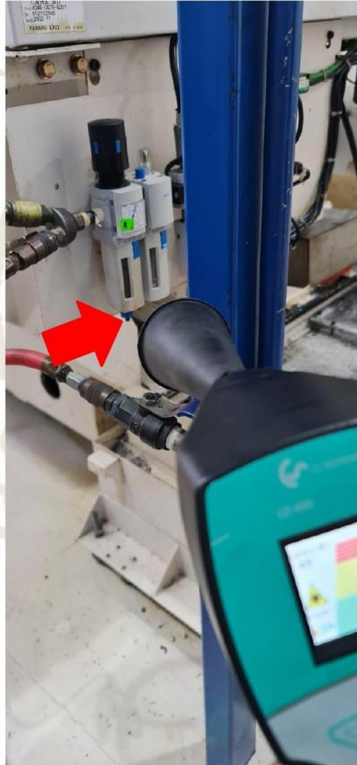
Fuga #13, 60dB registrados, M-016, en la unión de dos manguera flexibles para alimentar pistola de soplado.
