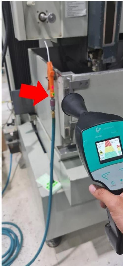
Fuga #9, 60dB registrados, M-005, en el distribuido de 2 salidas para manguera de 8mm.
