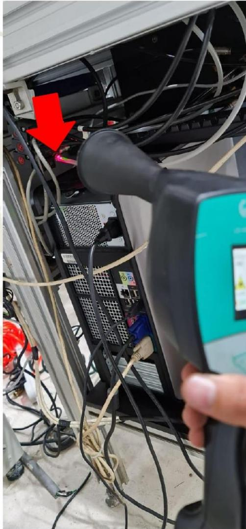
Fuga #4, 60dB registrados, STRG-A#3, salida del regulador en el Bushing de reducción.
