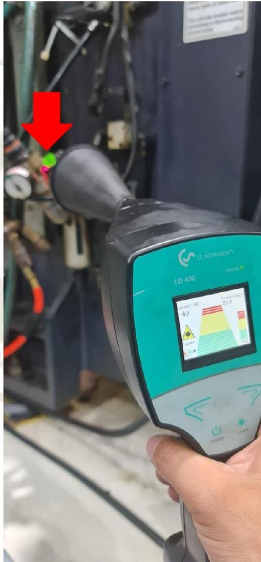
Fuga #17, 61 dB registrados, M-017, en la salida del regulador de presión, manguera flexible rota.
