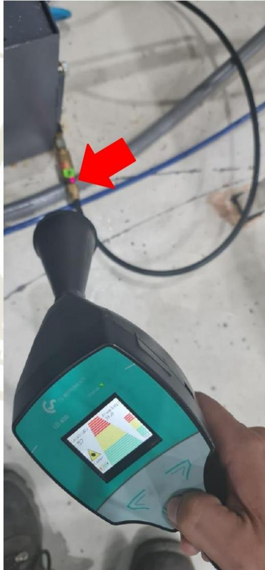
Fuga #19, 60 dB registrados, M-049, Acople roscado recto con conexión a manguera.
