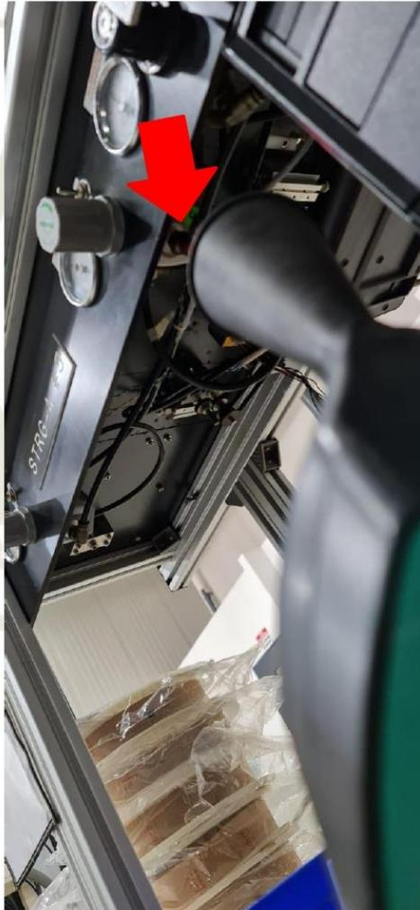
Fuga #6, 47dB registrados, SEMICONDUCTORES EDM, Salida de tubería, en la alimentación hacia la máquina, manguera negra.
