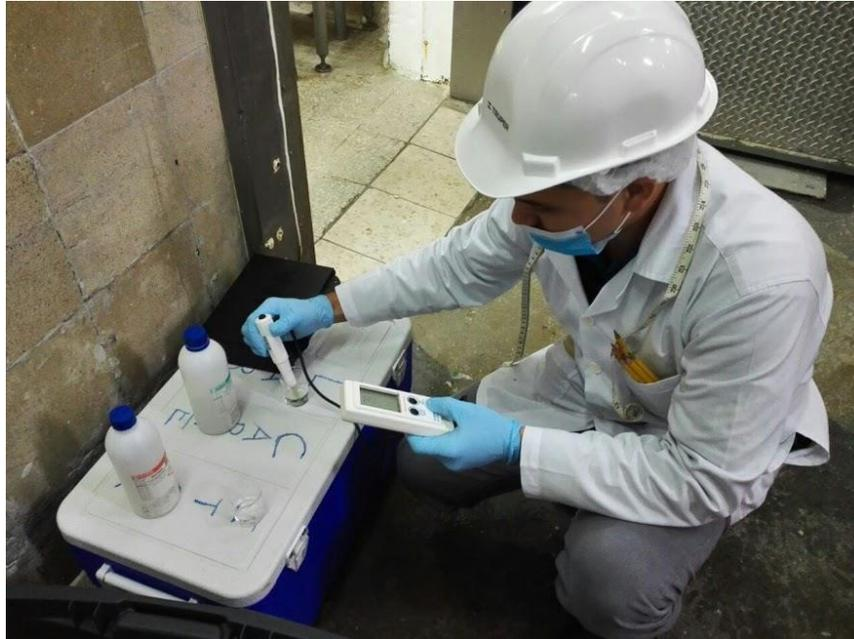
**Anexo 3.** Calibración del pH-metro en la planta de cosecha Coopemontecillos RL, para las mediciones de pH y temperatura.
