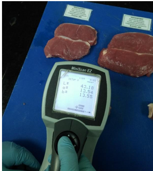
Figura 9. Espectrofotómetro HunterLab MiniScan EZ 45/0 utilizado para medir los parámetros de color L*, a*, b* de los bistecs del músculo Longissimus dorsi lumborum de terneros de encaste Brahman a los 2 y 7 días de maduración, Laboratorio Nacional de la Carne, Tecnológico de Costa Rica, San Carlos, Alajuela, Costa Rica, 2018.
