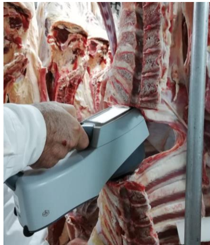
Figura 6. Espectrofotómetro HunterLab MiniScan EZ 45/0 utilizado para medir los parámetros de color L^* , a^* , b^* de las canales de terneros de encaste Brahman 24 horas post mortem , Coopemontecillos R. L., Alajuela, Costa Rica, 2018.
