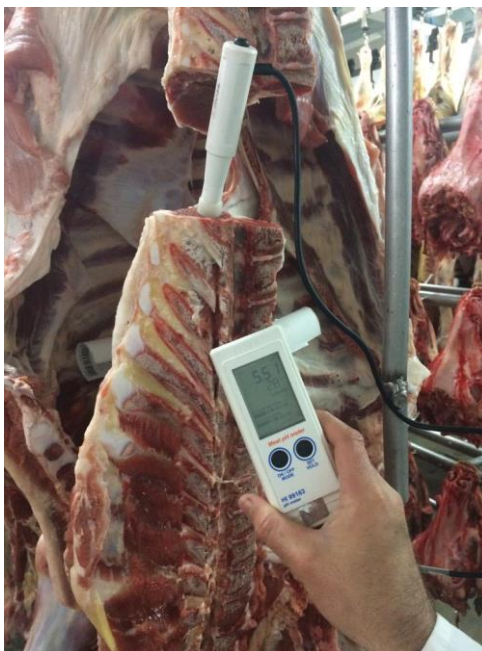
Figura 4. pH-metro Hanna Instruments Meat pH Meter HI 99163 utilizado para medir la temperatura (°C) y el pH de las canales de terneros de encaste Brahman 24 horas post-mortem, Coopemontecillos R. L., Alajuela, Costa Rica, 2018.
