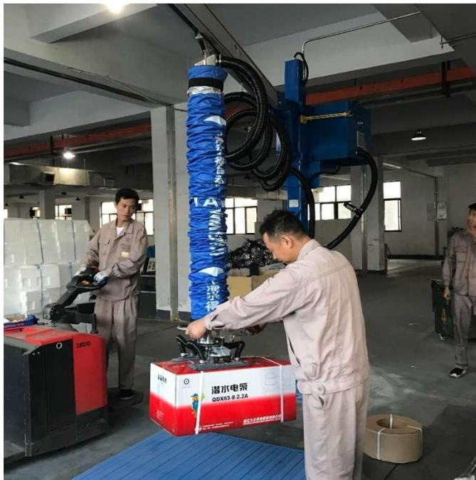
**Figura VII-6. Equipo de manipulación de cargas al vacío instalado**
