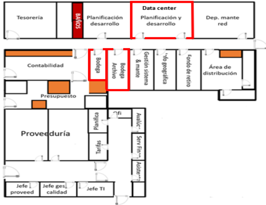
Figura 18. Distribución de compartimentación para Tesorería, proveeduría y Contabilidad con una propuesta de salidas adicionales
