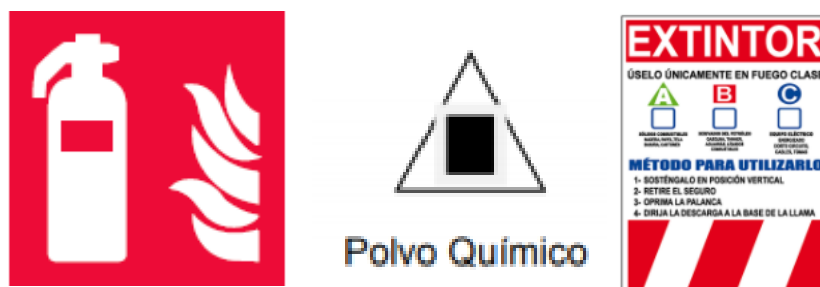
Figura 36. Señalización para extintores portátiles
