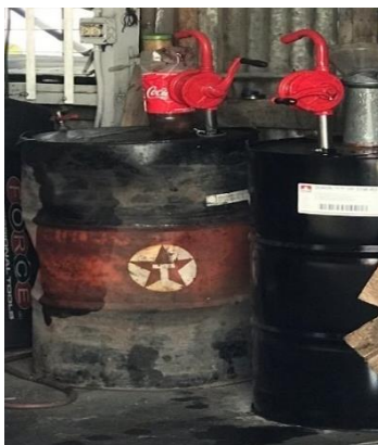
Figura 59. Sistema de trasvase por bombeo de palanca en los talleres mecánico y de motos de JASEC
