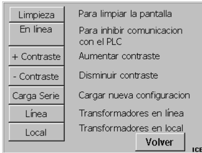
**FIGURA 6.16** PANTALLA PARA EL MANTENIMIENTO DEL PANEL
