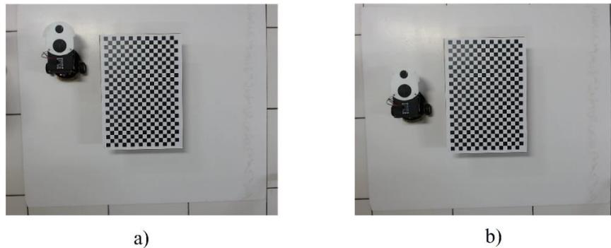
**Figura 4.7.** Movimiento del robot durante el experimento de avanzar 15 cm: a) antes del movimiento; b) después de la acción de control.
