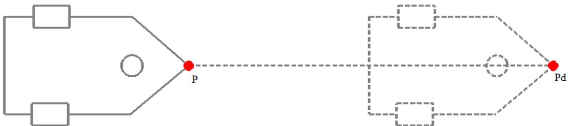
**Figura 3.9.** Generación de un camino tipo línea para el robot móvil diferencial.
