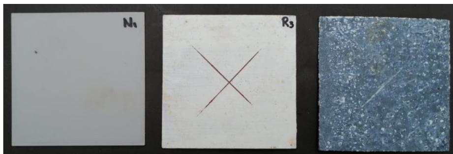
**Figure 4.20.** PET, 400 horas. A) Natural B) Recubrimiento comercial C) ZINGA.
