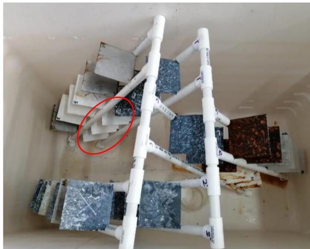
**Figure 4.22.** Posición del PET con recubrimiento comercial dentro de la cámara salina.
