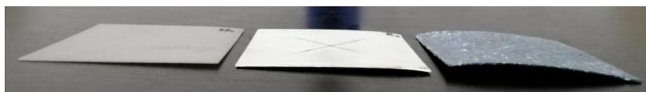
**Figure 4.21.** Pandeo de probetas PET después de las 400 horas en cámara salina.
