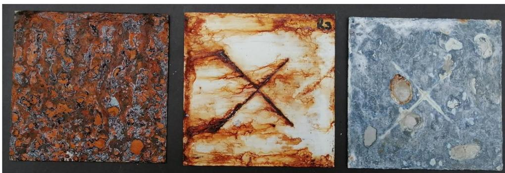
**Figure 4.19.** Acero bajo carbono 1020, 400 horas. A) Natural B) Recubrimiento comercial C) ZINGA.
