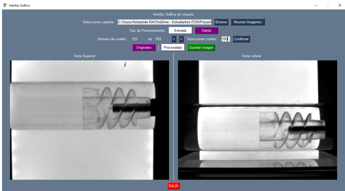
Figura 5.5: Resultado de imágenes originales capturadas en la salida del impulsor sin trazador. (Elaboración propia).
