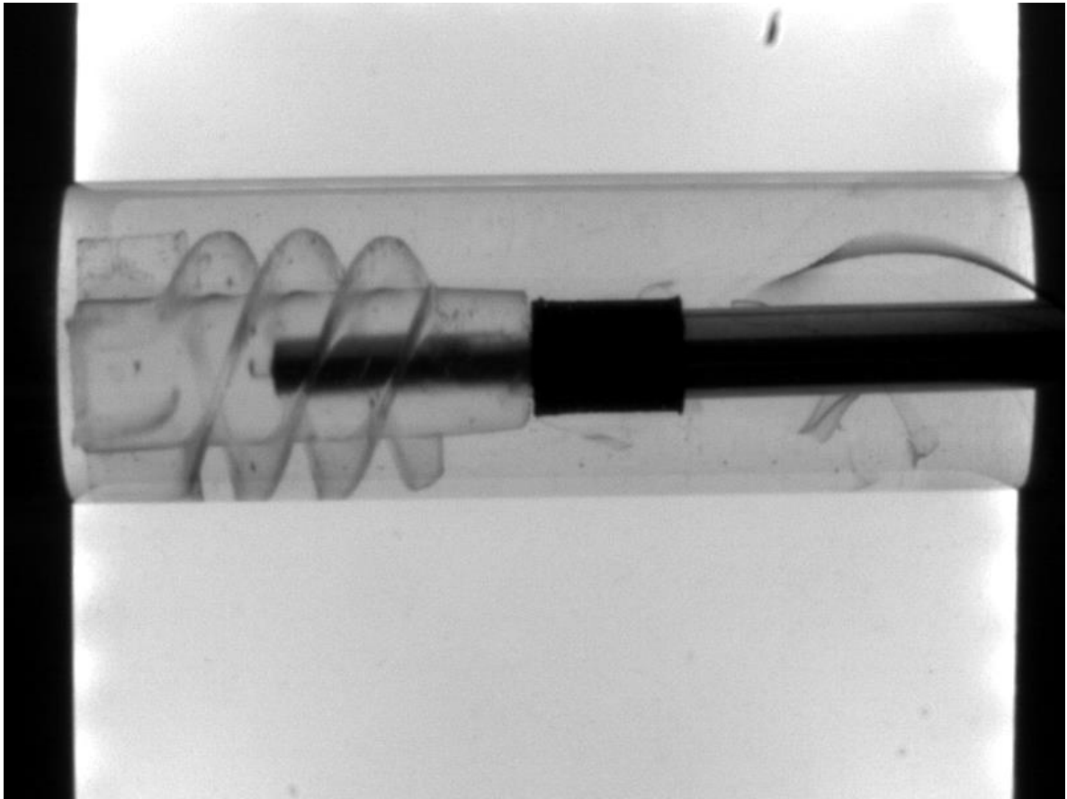
Figura 4.13: Imagen capturada con cámara Cognex en la planta para la entrada del impulsor, con tinta china Staedtler como trazador. (Elaboración propia).
