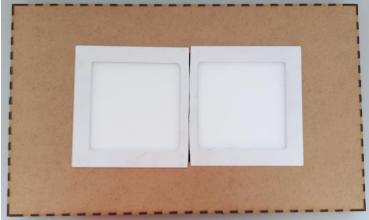
Figura 4.11: Diseño de backlight, para dos vistas paralelas. (Elaboración propia).
