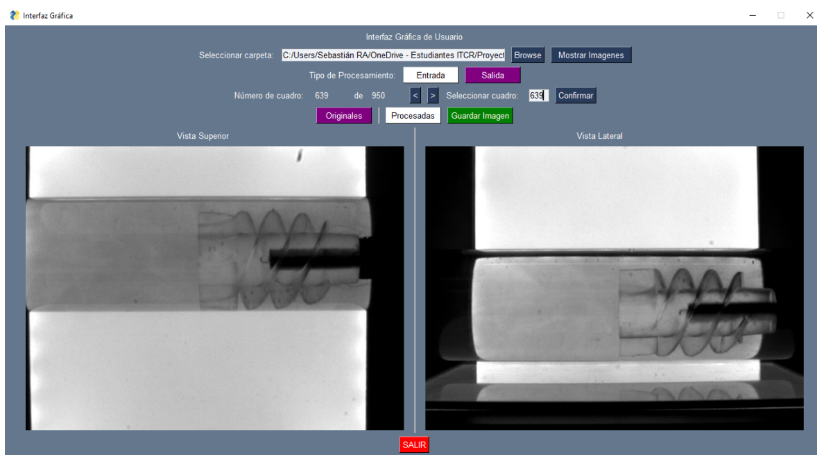
Figura 5.7: Resultado de imágenes originales capturadas en la salida del impulsor con trazador. (Elaboración propia).
