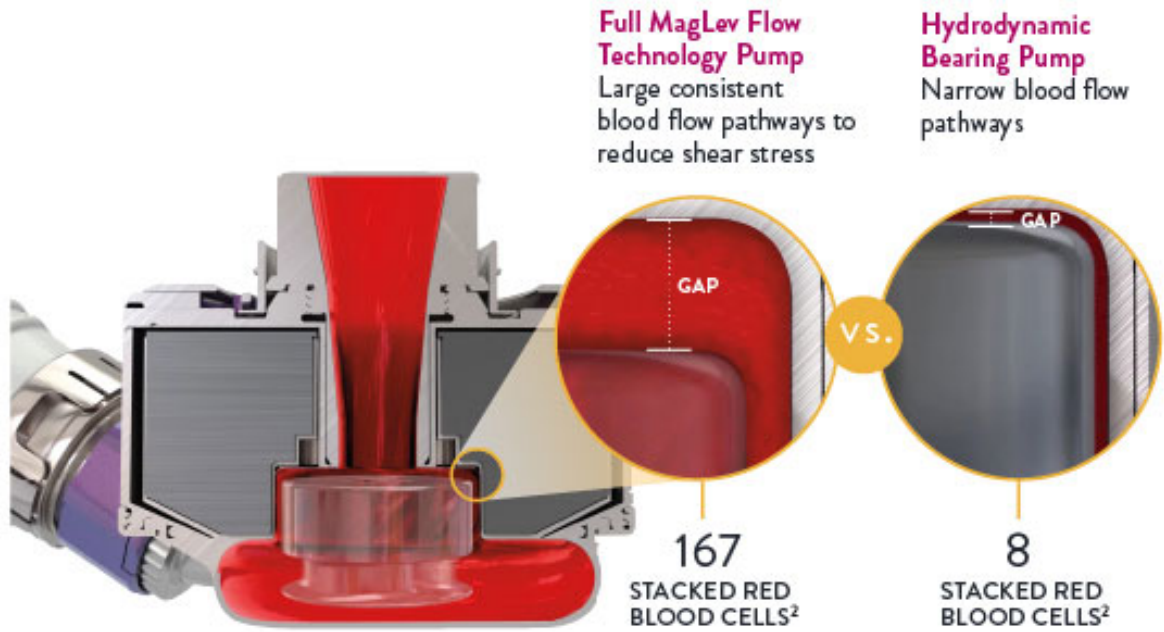
Figura 2.2: Vista de corte del LVAD Heartmate 3. (Recuperado de: [28]).
