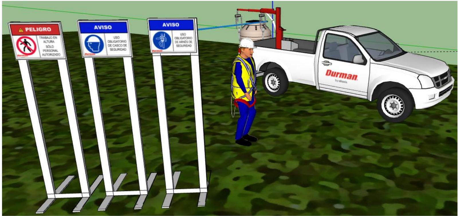
Figura 10. Ubicación de señalización en un proyecto de construcción con trabajos en alturas
