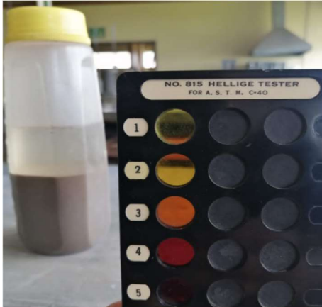
Figura 24. Comparación de la muestra ensayada con los vidrios de la escala Gardner
