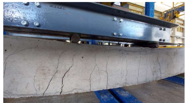
Figura 47. Ensayo a flexión de viga de concreto reforzado.
