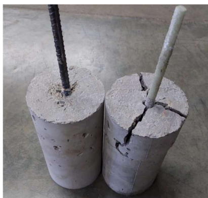
Figura 75. Daño del concreto en el ensayo comparativo de adherencia
