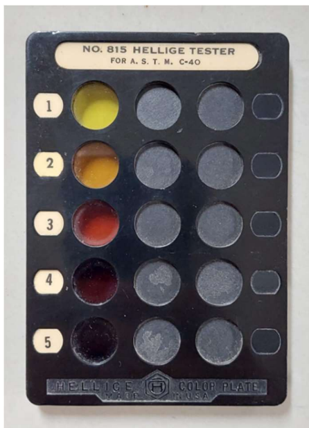
Figura 2. Escala Gardner utilizada para el ensayo de colorimetría.
