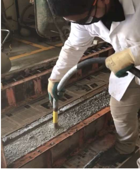
Figura 41. Vibrado de la segunda capa del concreto de la viga reforzada.
