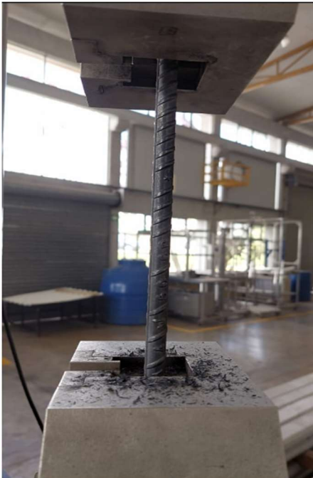
Figura 31. Varilla durante ensayo a tracción en máquina universal.
