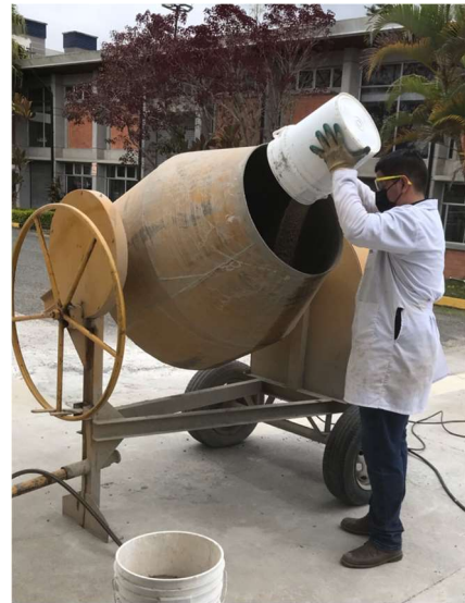
Figura 39. Elaboración de la mezcla de concreto.
