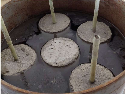
Figura 51. Curado de las probetas del ensayo de extracción.
