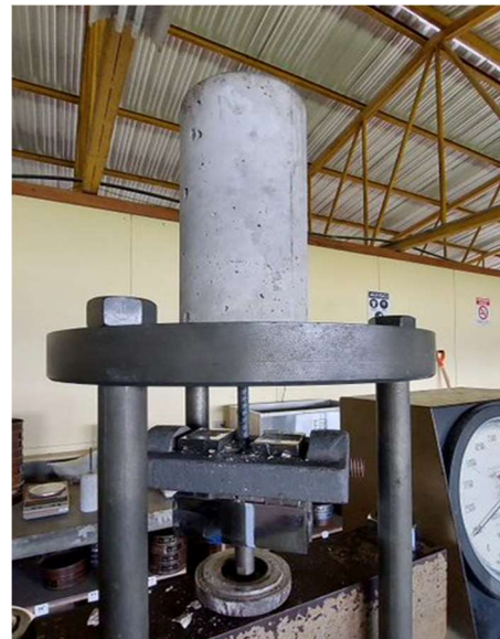
Figura 50. Ensayo de extracción.
