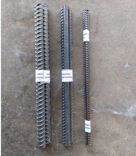
Figura 30. Muestreo de las varillas de acero de diferentes diámetros.
