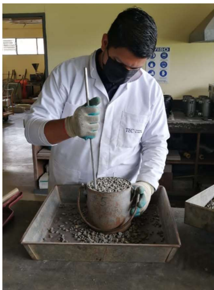
Figura 28. Procesos de varillado del agregado grueso
