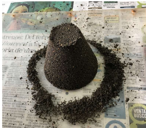
Figura 25. Prueba para comprobar la condición de humedad y del agregado fino
