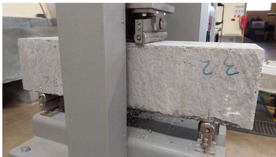
Figura 45. Proceso de ensayo de determinación del módulo de rotura.
