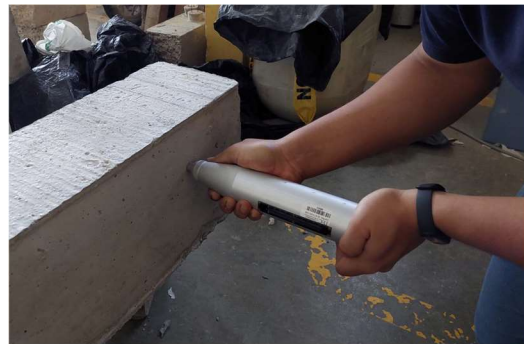
Figura 48. Ensayo con el esclerómetro
