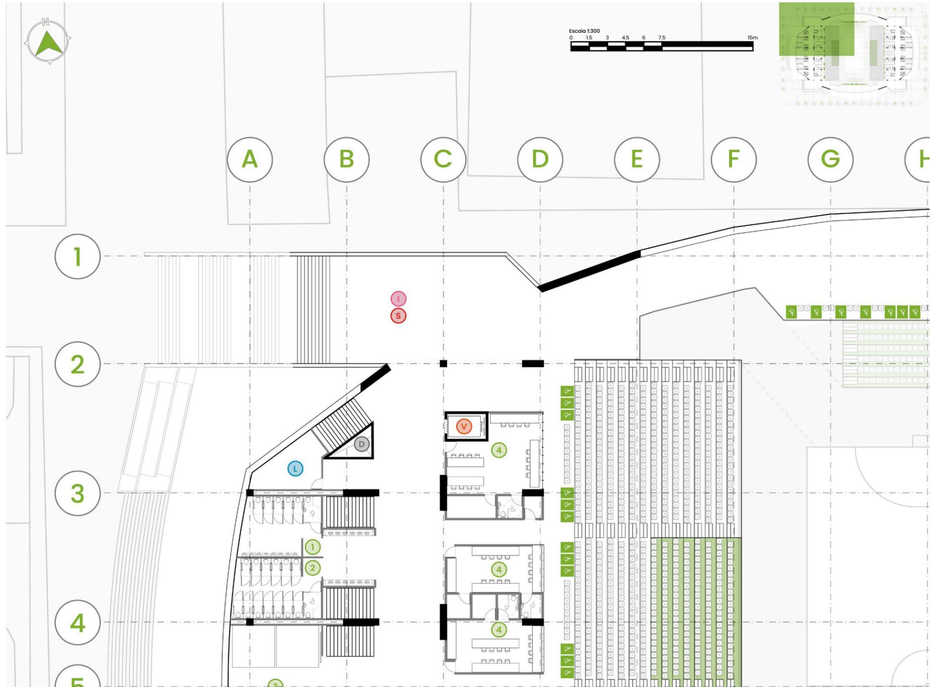
Figura 101. Detalle de planta nivel 3 sección noroeste. NPT 8.4 metros. Escala 1:300. Elaboración propia.
