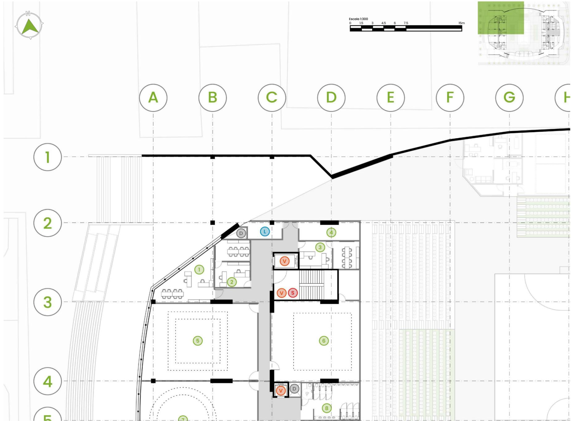
Figura 96. Detalle de planta nivel 2 sección noroeste. NPT 4.2 metros. Escala 1:300. Elaboración propia.
