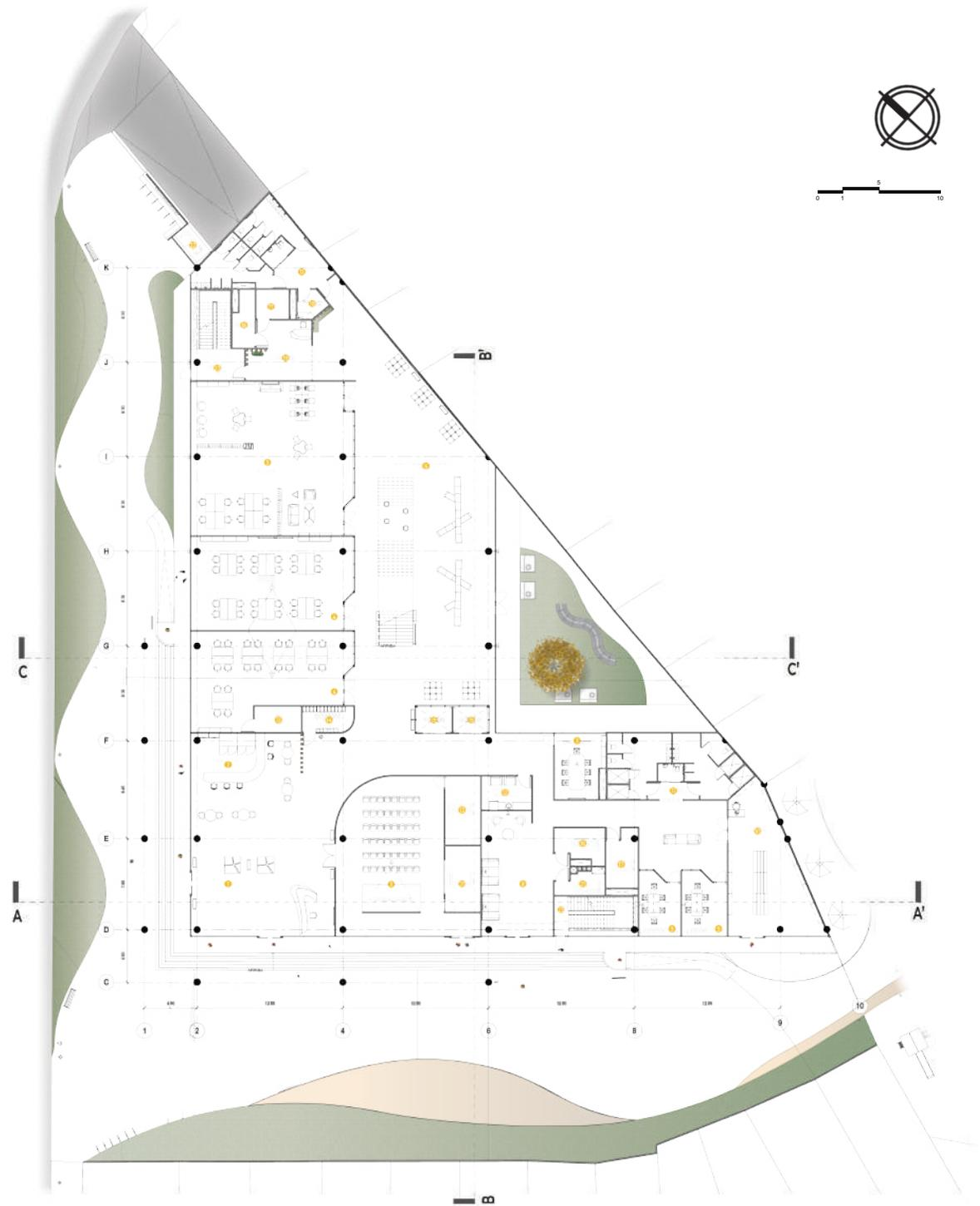
Figura 5.33: Planta de distribución arquitectónica. Primer nivel.
