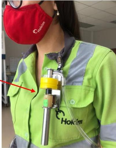
Figura 3. Colocación del tren de muestreo en el trabajador
