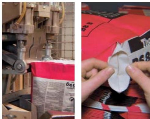
Figura 22. Sellado de los sacos mediante sistema de ultrasonido
