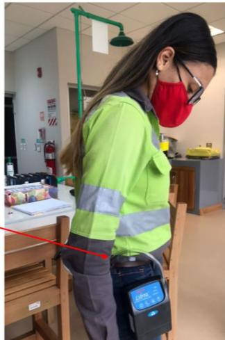
Figura 2. Colocación del tren de muestreo en el trabajador
