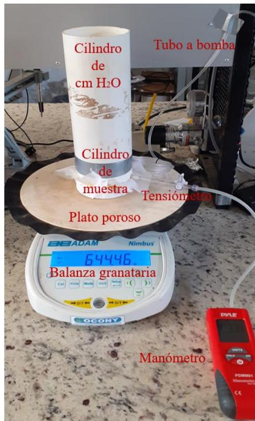
**Figura 16.** Equipo para la recolección de datos de la CCRA de las arenas hidrofóbicas
