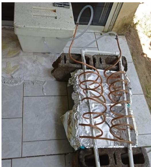
**Figura 3.** Cosecha de agua mediante condensación de aire
