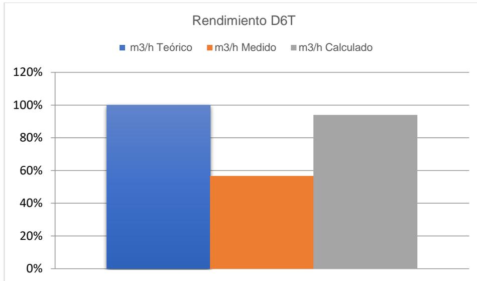
Figura 12. Rendimientos del tractor D6T
