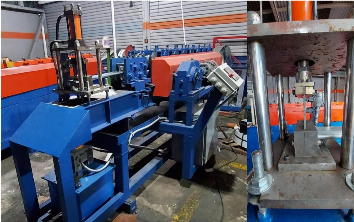
*Figura 4.4 Sistema de corte implementado en la máquina*
