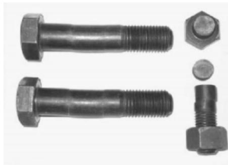
**Figura 21.** Deformación en dos planos en pernos sujetos a cortante.
