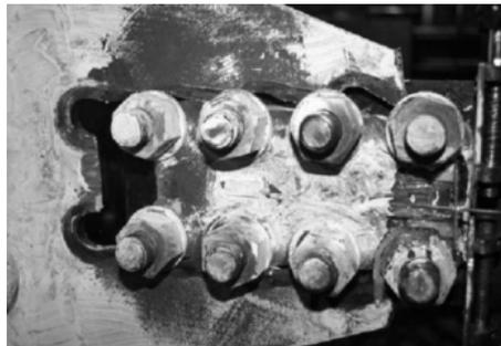
**Figura 31.** Falla por desprendimiento del bloque de cortante.
