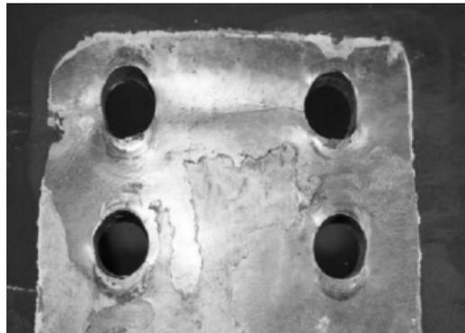
**Figura 29.** Placa deformada por aplastamiento por pernos.
