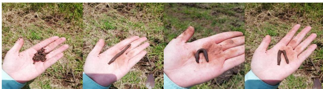
Figura 14. Prueba de campo de plasticidad y adhesividad
