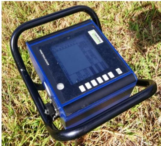
Figura 12. Penetrologger Eijelkamp en el área experimental
