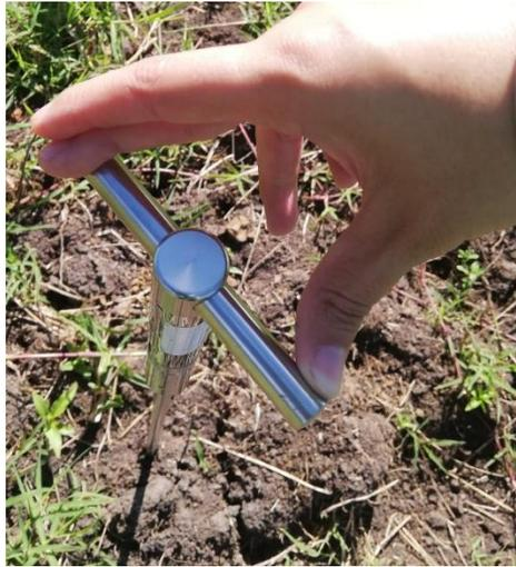
Figura 13. Veleta de corte en el área experimental
