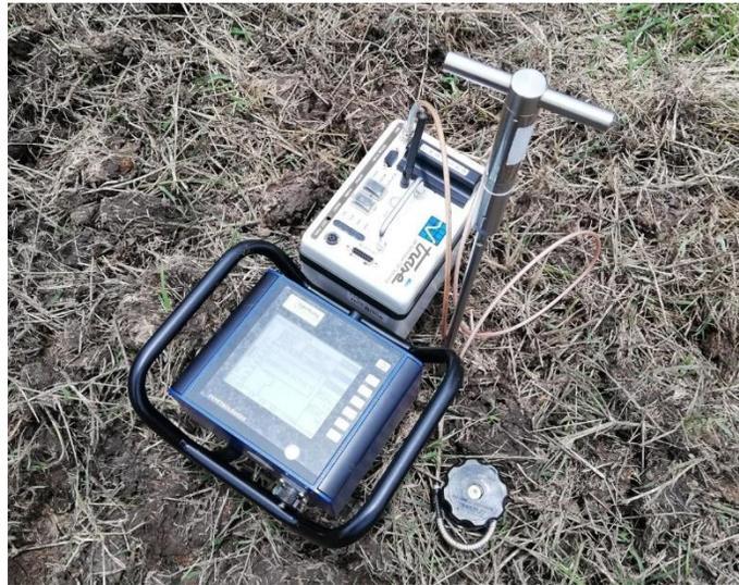
Figura 10. Medición de características mecánicas del suelo en un punto de muestreo
