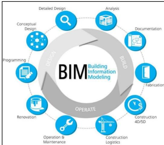
Figura 1. Procesos ligados a las etapas de un proyecto de construcción
