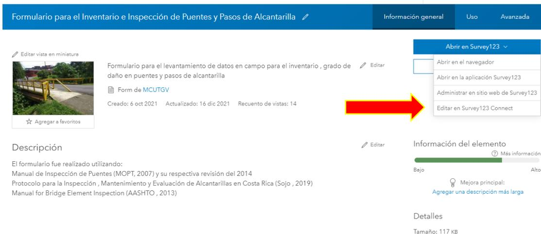
Imagen 4: Vista de la pantalla del *Arcgis Online* en la pestaña de Formulario para el inventario e Inspección de Puentes y Pasos de Alcantarilla para abrir el Survey 123 Connect.
