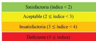
**Figura 7: Clasificación del Índice de Condición Estructural (BCI)**
