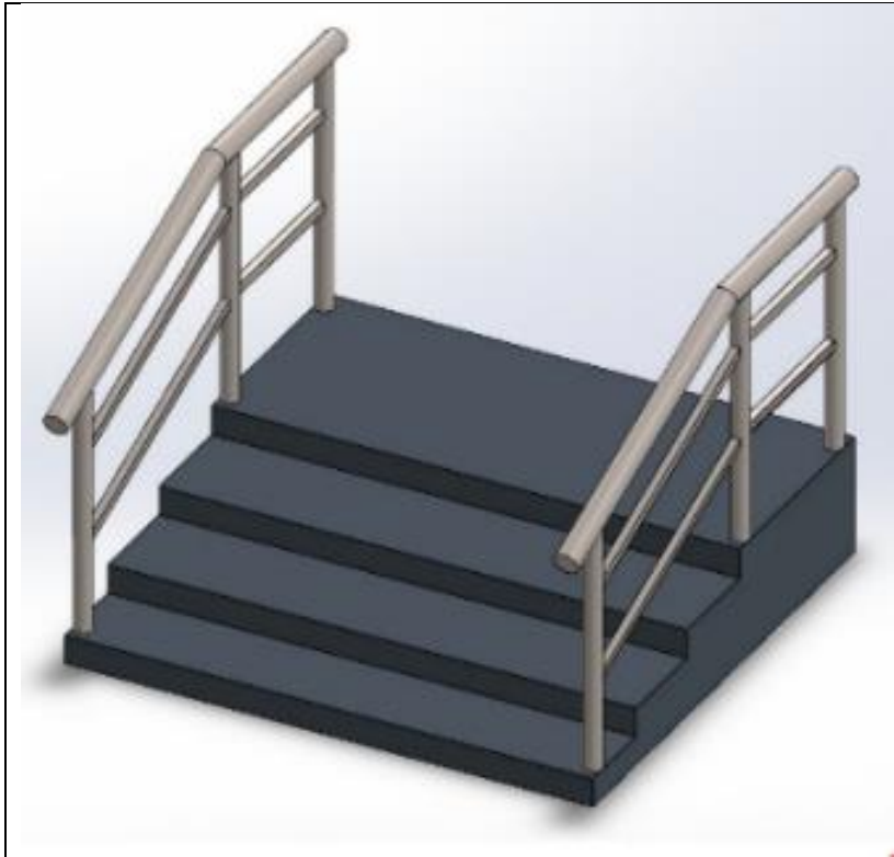
Figura 12. Escalera y pasamanos para evacuación
