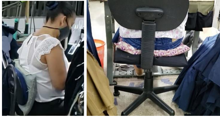
Figura 38. Sillas sin adecuado soporte lumbar y asiento.
