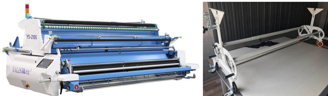
Figura 16. Ejemplos de máquinas tendedoras de tela automática y manual.
