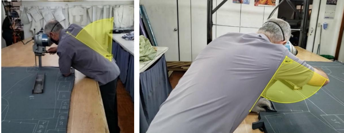
Figura 19. Postura forzada por hiperflexión de la espalda y abducción de brazo mayor a 60°.
