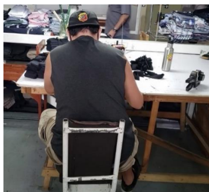
Figura 27. Silla de trabajo del puesto de etiquetado sin respaldar adecuado.
