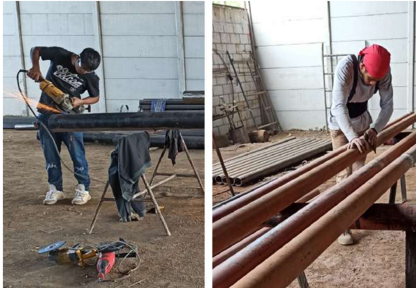
Figura 27. Pulido de empalme con esmeril y acabado final de tubo de hierro Fuente: Autoría propia.
