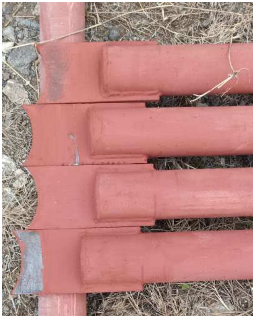
(g) Acabado final de los tubos de hierro con placas y tapas. Fuente: Autoría propia.
