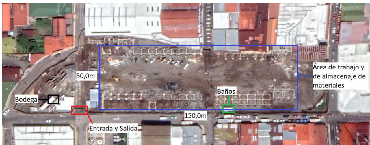
Figura 23. Diseño de sitio en Alajuela de Grupo Constructora JDD Ltda. Fuente: Autoría propia, en software Google Earth®.
